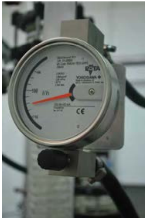
Figura 2.7. Sistema di misura e regolazione della portata di solvente.
