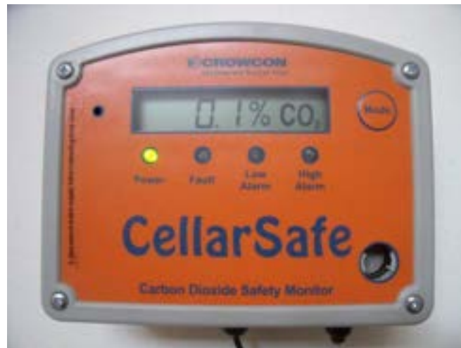
Figura 2.13. Misuratore di CO 2 .
