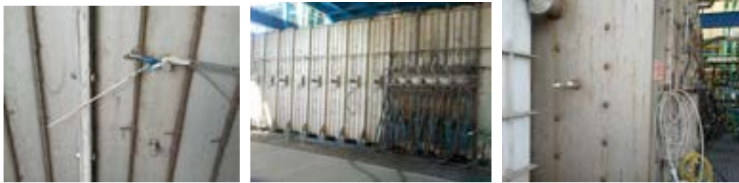
Figura 2 Nelle foto a, particolare sonda ODC. Foto b e c sono riportati i punti di accesso per le sonde ODC. Foto b sono bocchelli radiali, foto c è il bocchello per l'osservazione assiale-frontale
