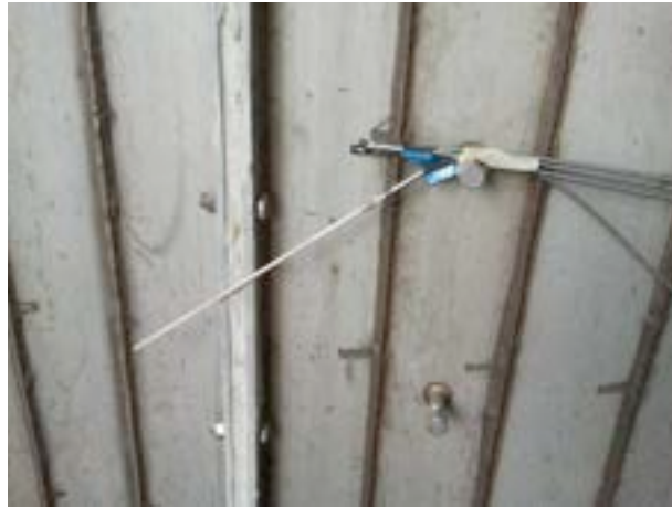
Figura 6 Sonda ad alta temperatura (zaffiro) con relativo cavo in fibra ottica corazzata
