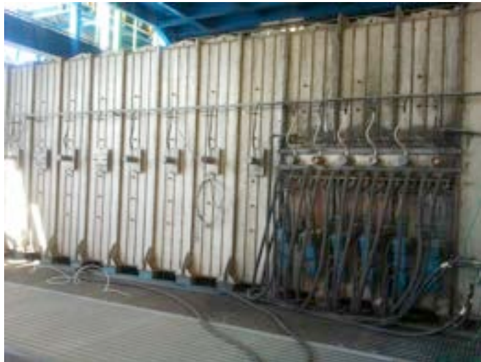
Figura 5 Fianco del forno FOSPER su cui sono disponibili i bocchelli per effettuare osservazioni dirette in camera di combustione
