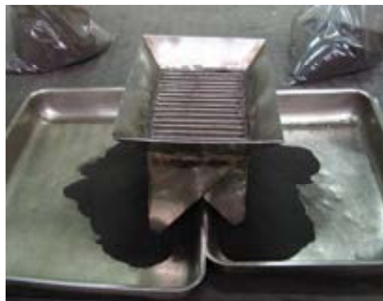
Figura 5.5. Campionatore; operazione di prelievo di un campione rappresentativo.
