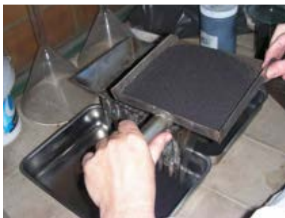
Figura 5.5. Campionatore; operazione di prelievo di un campione rappresentativo.
