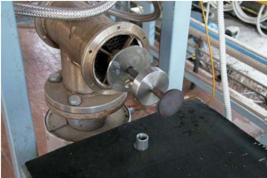
Figura 7: Bruciatore TVC privo del liner esterno in quarzo. In basso al centro è possibile vedere il posizionamento del rivelatore di fiamma.
