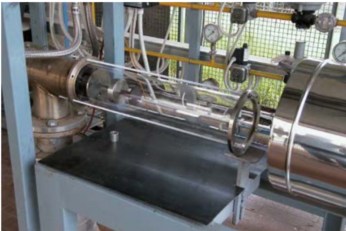
Figura 8: Bruciatore TVC inserito all'interno del liner in quarzo ottico che ne costituisce la camera di combustione.
