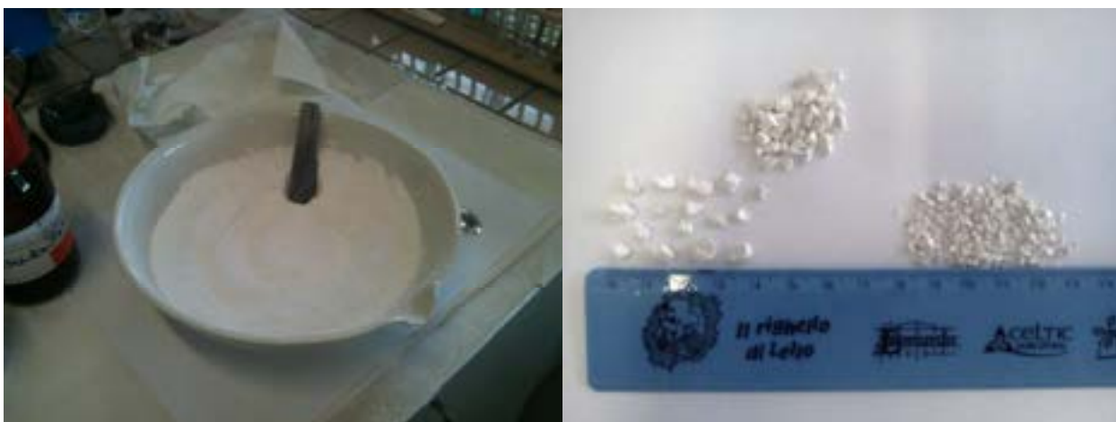
Figura 6. Aspetto macroscopico del composito Zn_TS_30_T500 sotto forma di polvere (a sinistra) e in pellet di varia granulometria (a destra)
