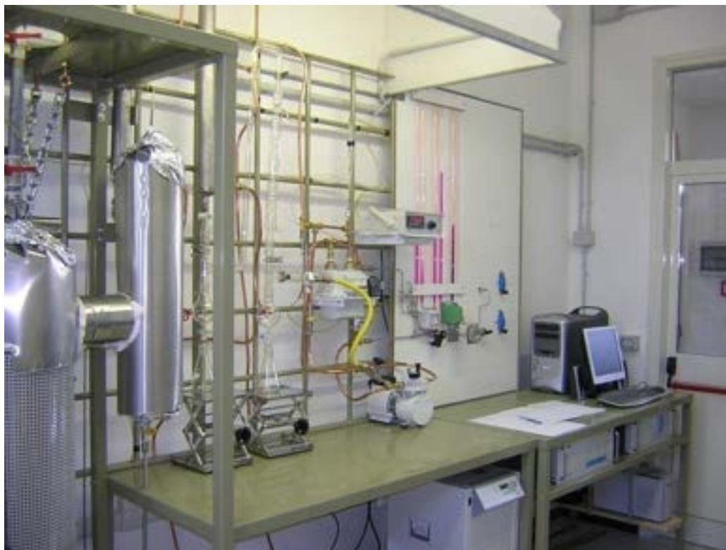
Figura 4 Impianto di gassificazione a letto fluido in scala pilota di laboratorio
