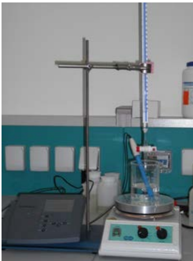
Figura 2.7. Fase di titolazione della metodica SINTEF.
