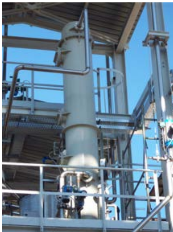
Figura 2.1. Secondo stadio di desolforazione a freddo.
