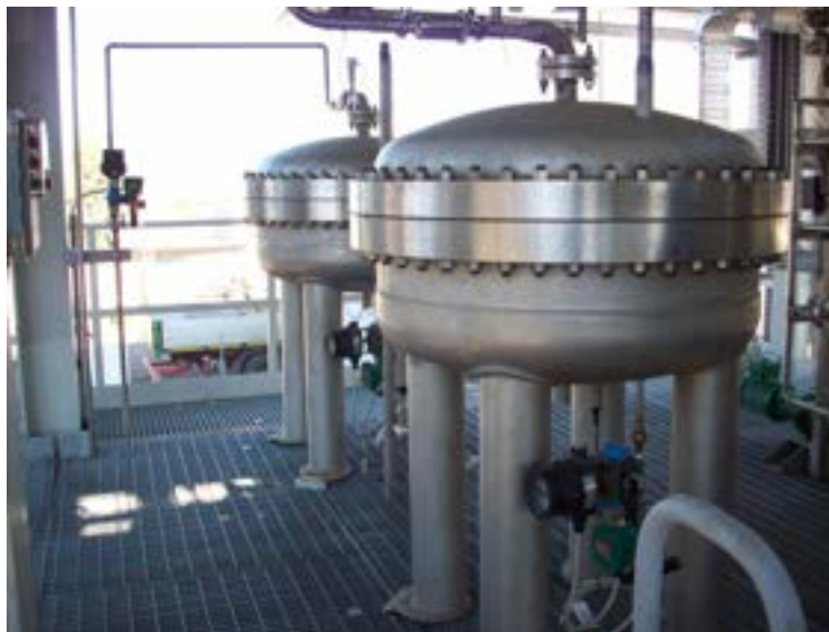
Figura 2.3. Reattori di assorbimento dell'anidride carbonica.
