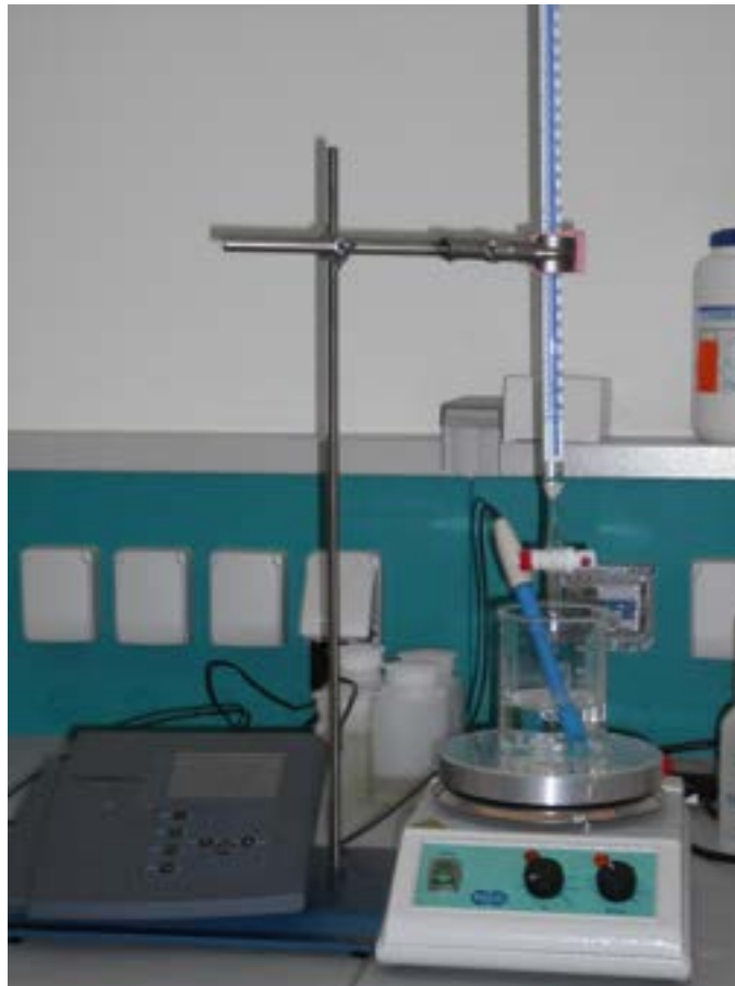
Figura 2.8. Fase di titolazione della metodica SINTEF
