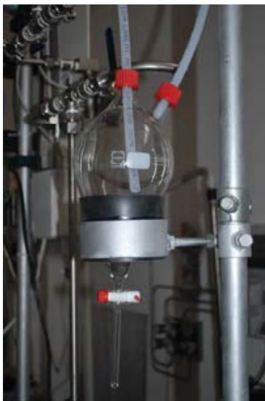
Figura 2.15. Sistema di separazione e scarico della condensa.
