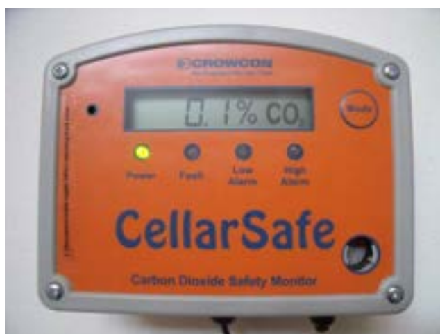
Figura 2.22. Misuratore di CO 2 .
