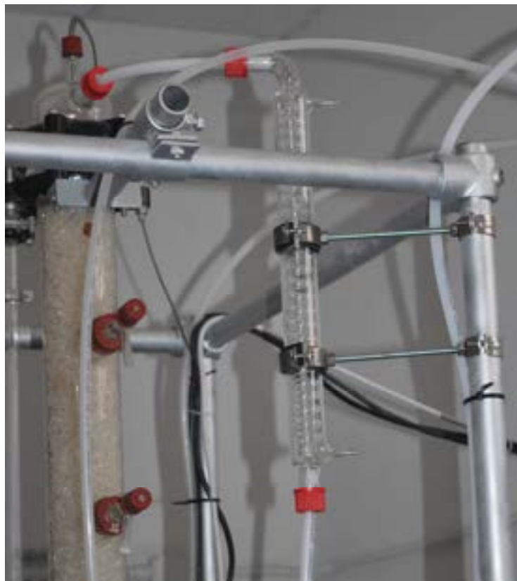
Figura 2.14. Sistema di condensazione.
