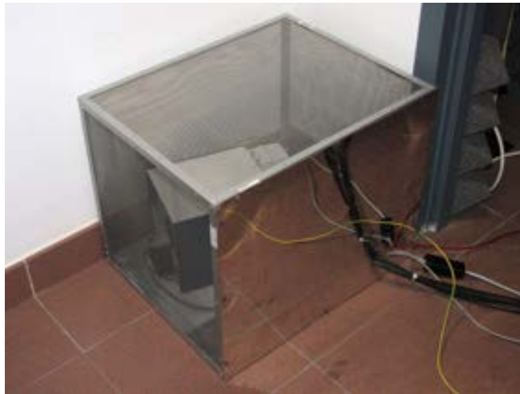
Figura 2.25: gabbia di Faraday che racchiude il sistema di acquisizione SCXI-1600.
