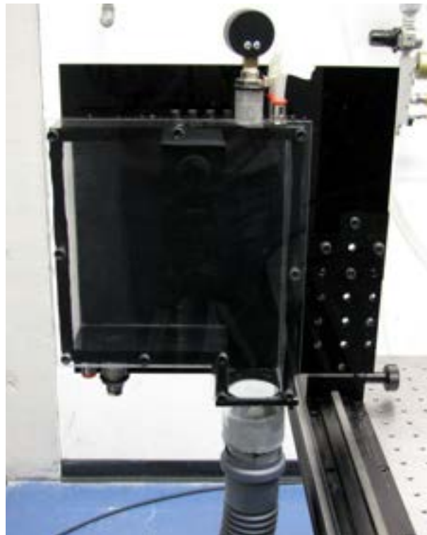
Figura 2.10: Modello di combustore TVC per misure PIV.
