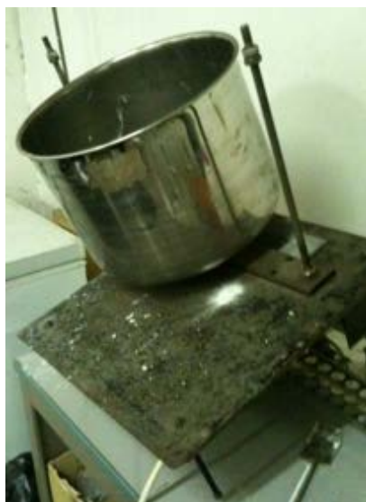
Figura 42. Corpo cilindrico centrale del reattore di granulazione.
