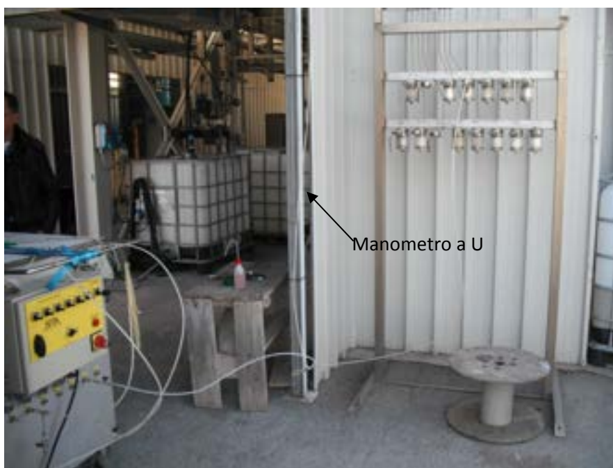
Fig. 20 - Manometro a U per la misurazione della pressione all'ingresso del \mu -GC
