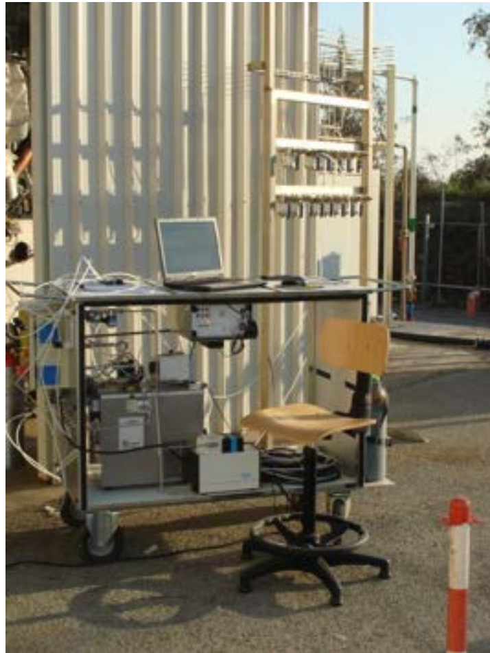
Fig. 1 – Sistema di campionamento e analisi gas tramite micro-GC
