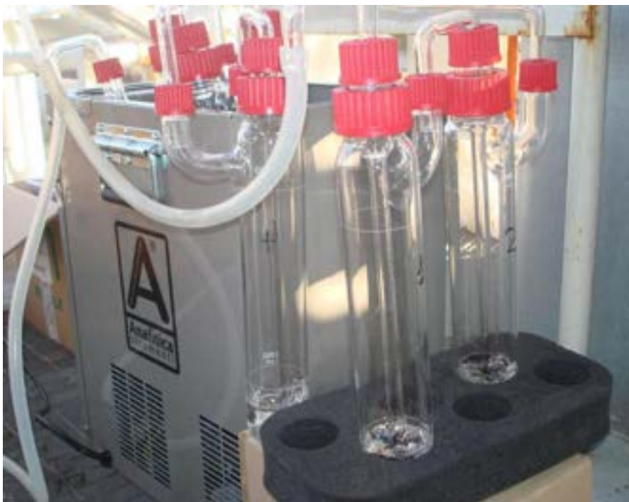
Fig. 44 – Sistema di sei assorbitori collegati in serie per la separazione del TAR dal syngas da gassificazione del carbone
