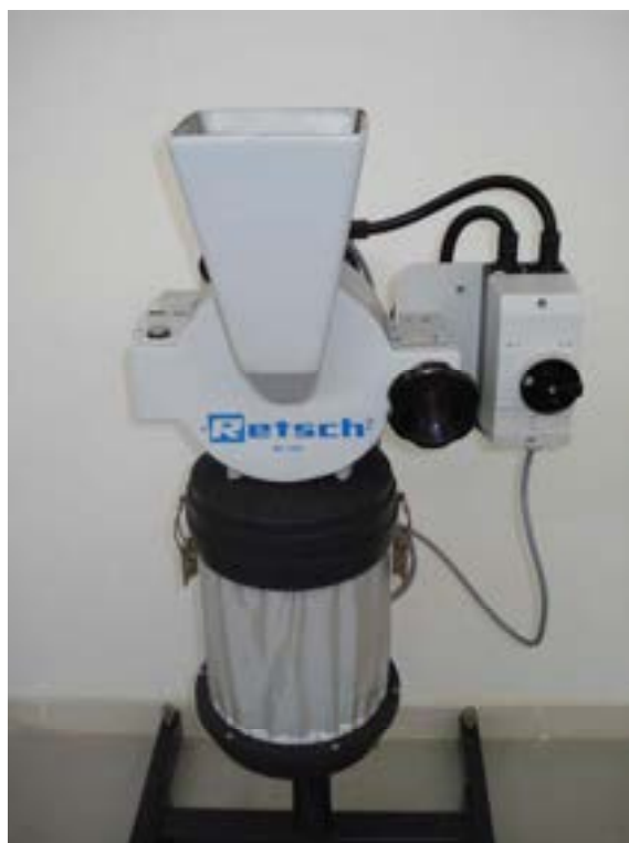
Fig. 23 – Mulino a croce SK100 per la macinazione del campione
