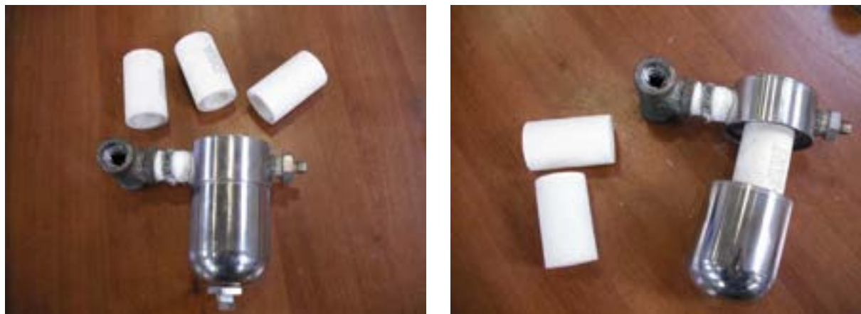
Fig. 11 - Filtri a freddo per la rimozione di polveri, TAR e umidità
