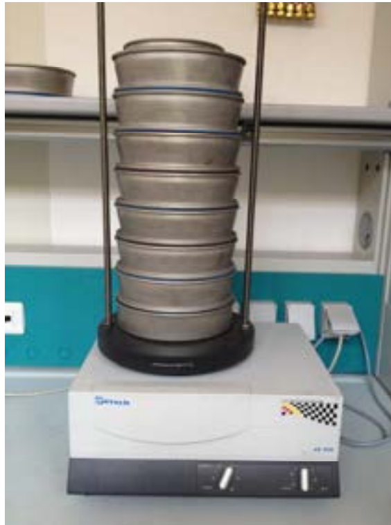
Fig. 22 – Mulino a vibrazione AS200 Retsch per l'analisi granulometrica
