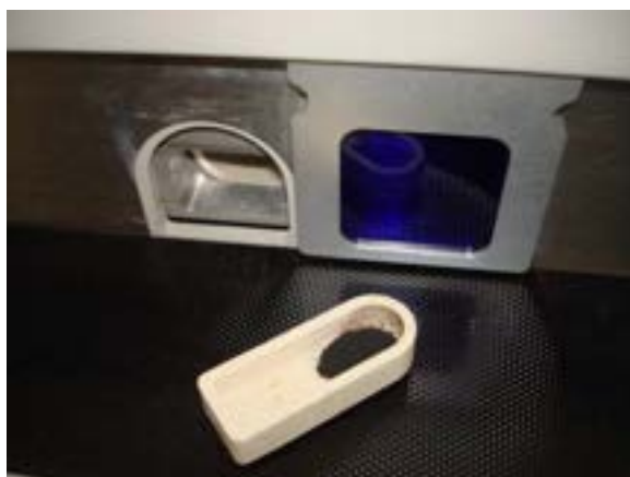
Fig. 26 – Fornace, crogiolo e campione per l'analisi al modulo S
