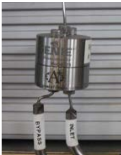
Fig. 2 - Membrana con filtro posta all'ingresso del micro-GC
