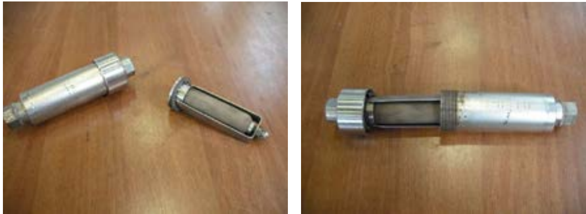
Fig. 10 - Filtri ceramici per la rimozione di polveri, TAR e umidità
