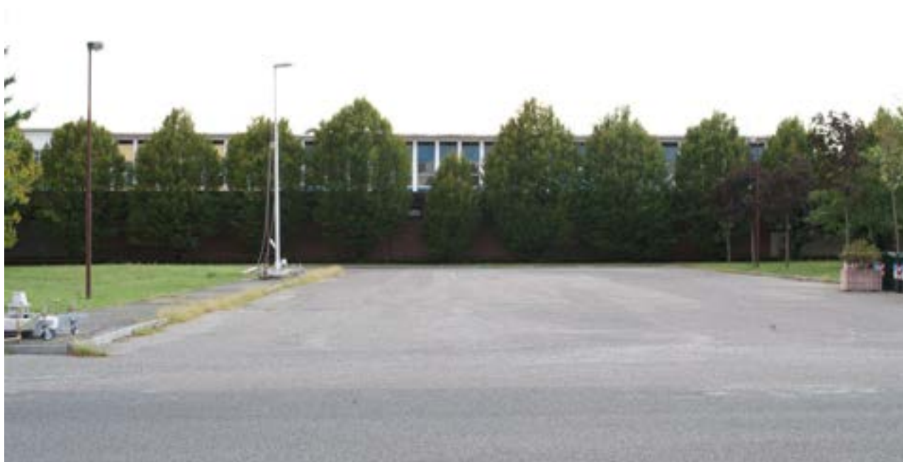
Figura 6 Strada e impianto di illuminazione presente nel sito scelto presso la sede INRIM (Il primo palo a sinistra appartiene all'impianto fisso INRIM, spento durante le prove, il secondo è quello sperimentale).
