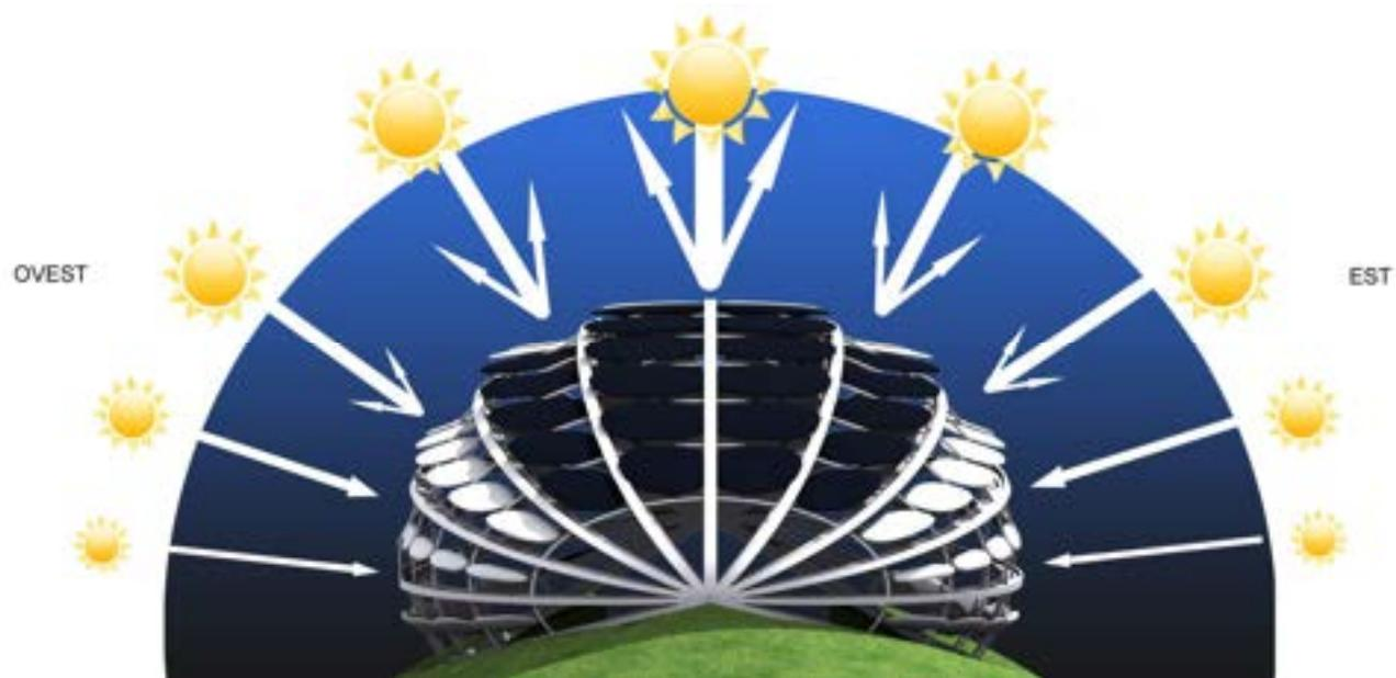
Figura 5 - La struttura schermo l'irraggiamento solare nelle ore più calde. I venti provenienti da EST e da OVEST possono invece circolare liberamente.
