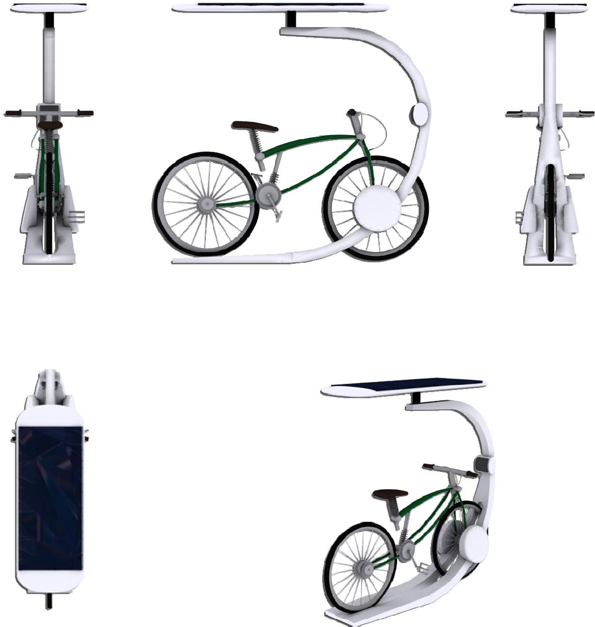
Figura 24 - Proiezione ortogonale di un modulo per il parcheggio di biciclette
