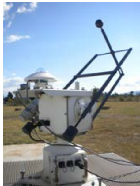
Dettaglio del sistema ad inseguimento biassiale per il monitoraggio della radiazione solare diretta
