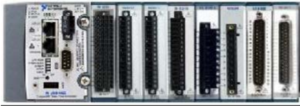
Immagine del sistema NI-CompactRIO della National Instruments utilizzato per l'acquisizione dei dati sul circuito d'essai per prove indoor su collettori solari
