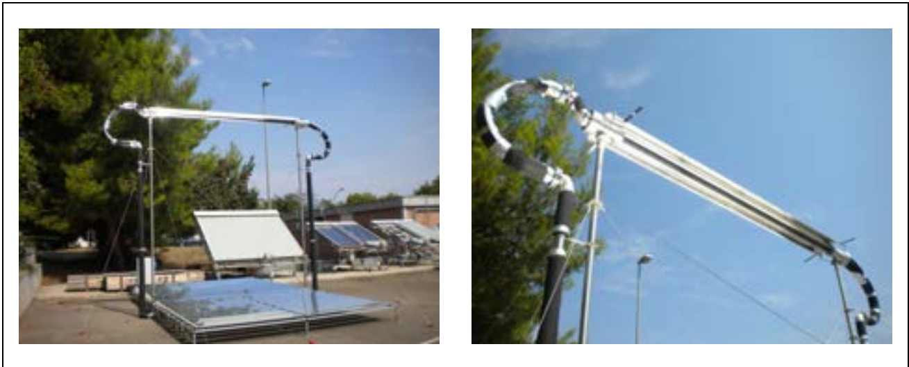
Foto del concentratore a specchi di Fresnel della ditta DWA in fase di test
