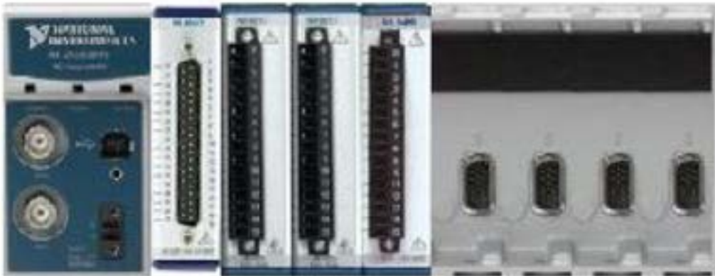
Immagine del sistema NI-CompactDAQ della National Instruments utilizzato per l'acquisizione dei dati sul circuito di prova degli accumuli
