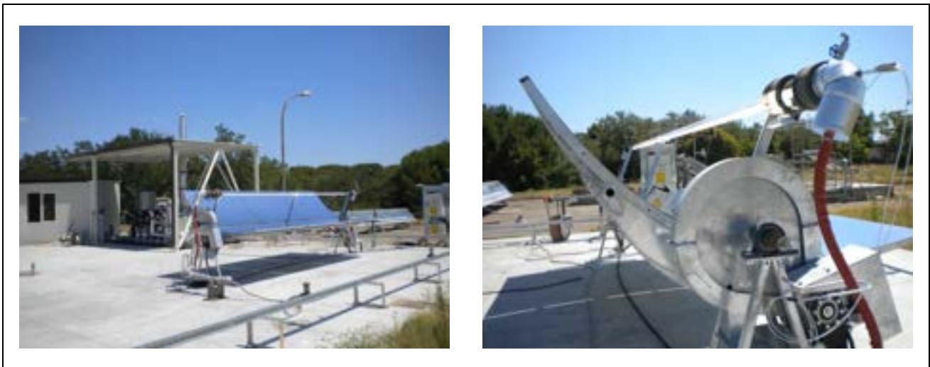
Foto del concentratore parabolico lineare della ditta SOLTIGUA in fase di test
