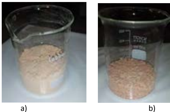
Figura 21- Sali/Diatomite in rapporto 80/20 prima di essere miscelati (a) e dopo essere stati miscelati in forno (b).
