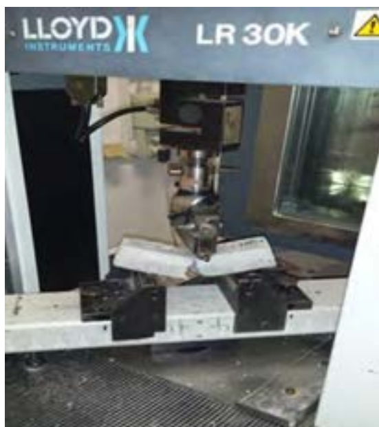
Figura 26- Provino sottoposto a flessione.
