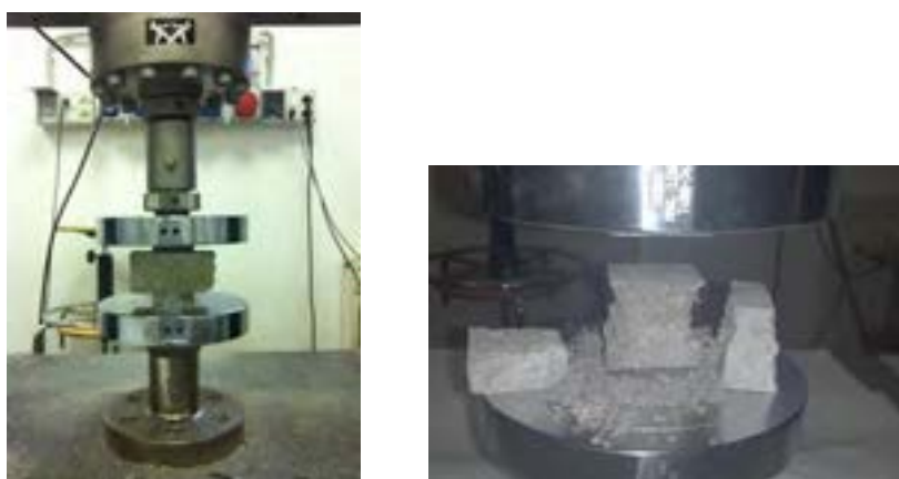
Figura 29- Provino sottoposto a compressione.
