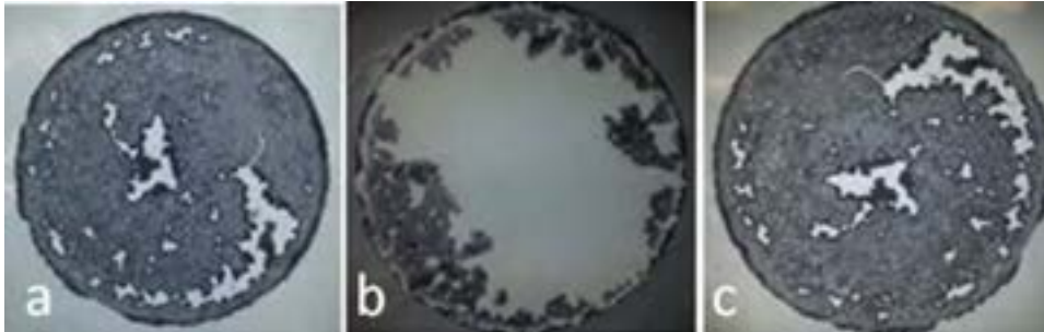
Figura 6 - Miscele con diverse concentrazioni di GNP: a) 0,2% b) 0,5%, c) 1,0%.
