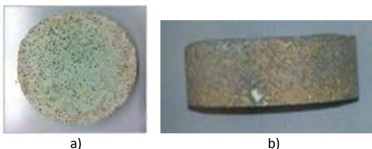
Figura 31- Provini per la conducibilità e diffusività termiche: malta+ sali/diatomite (a) e di malta+sali in capsule (b).
