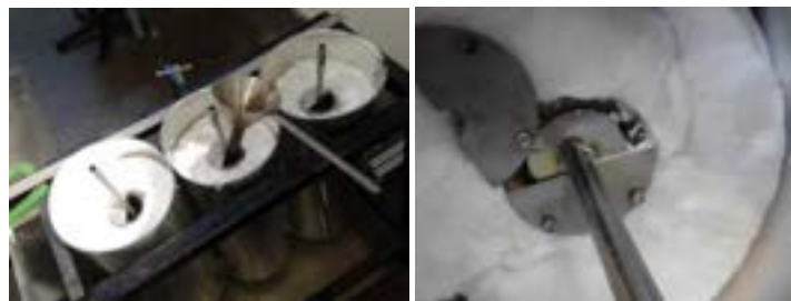
Figura 3- Fasi di riempimento di una terna di accumulatori elementari coibentati contenenti PCM
