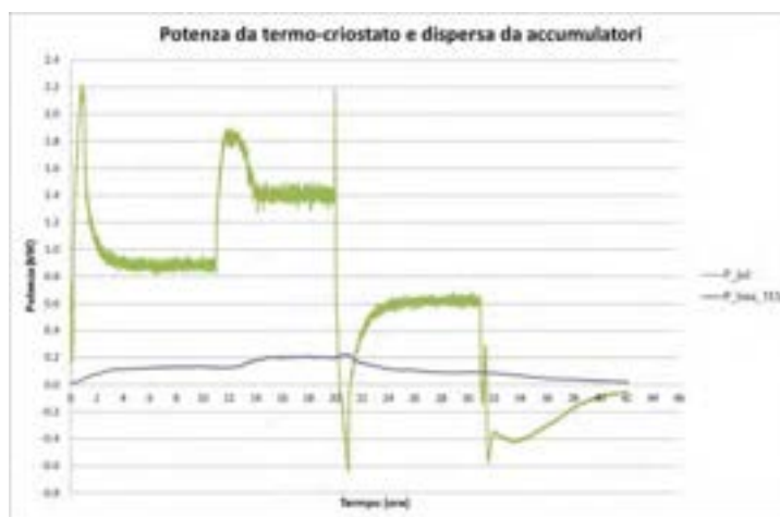
Figura 15 - Potenza assorbita dall'impianto e dispersa dagli accumulatori per la Prova 1.2
