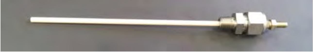
Figura 2: Testa ottica con fibra di zaffiro monocristallino ( \Phi = 2 \text{ mm} ) in un tubo protettivo di allumina ( \Phi \approx 5 \text{ mm} ).
