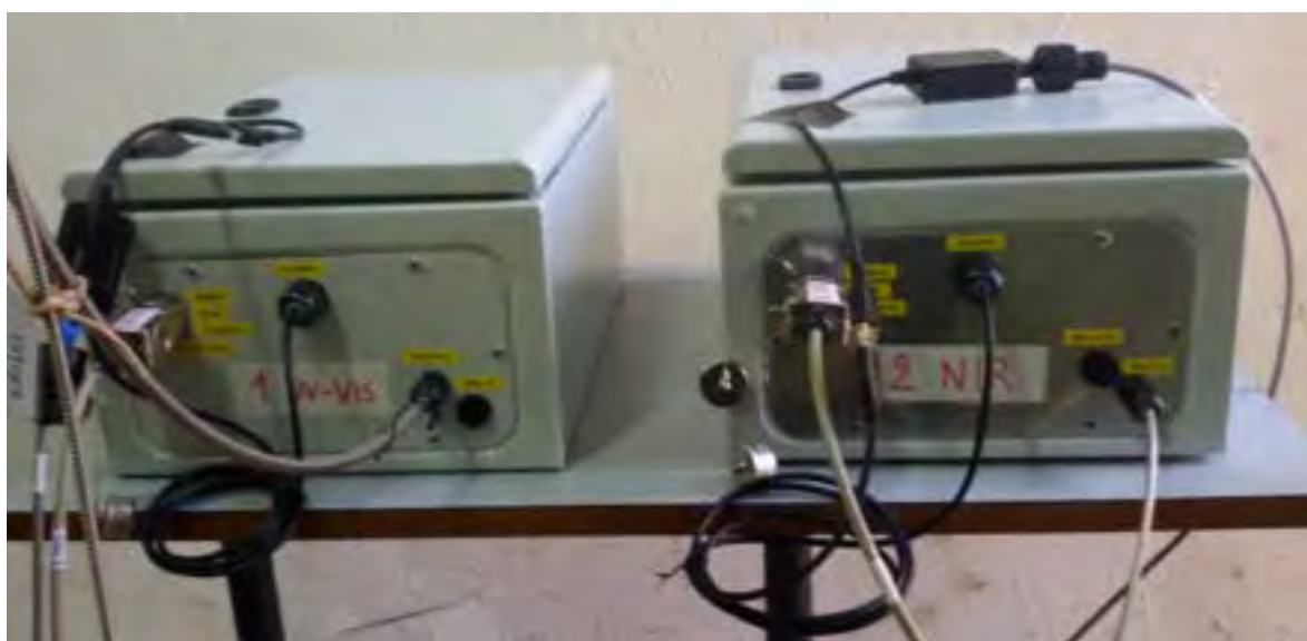
Figura 4: Contenitori ATEX all'interno dei quali sono posizionati i sistemi ODC con la ruota porta-filtri per i range UV-VIS e NIR.
