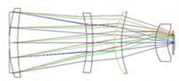
Fig. 10. Esempio del sistema di proiezione dell'immagine sul CCD della camera preceduto da un filtro interferenziale variabile per la selezione spettrale.
