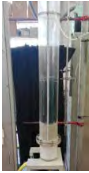
Figura 21. Colonna in plexiglas con il sistema modulo membrana per la fluidizzazione del solido (olivina) con aria, diametro interno = 144 mm
