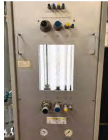
Figura 22. Banco rotametri "Varisco Cariatì" alimentati con aria di rete
