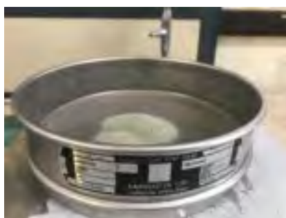
Figura 27. Setaccio INOX ISO – 565, diametro 250 \mu\text{m}
