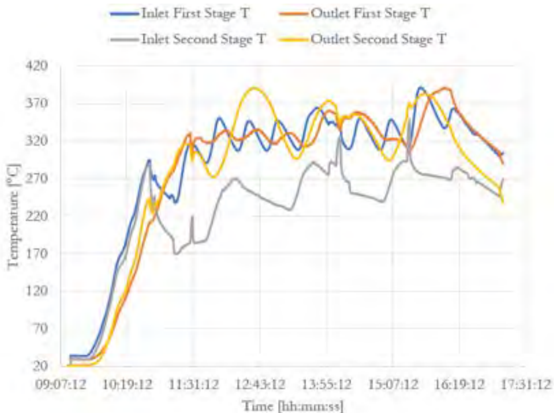
Figura 6.1. Andamento tipico delle temperature nel reattore.
