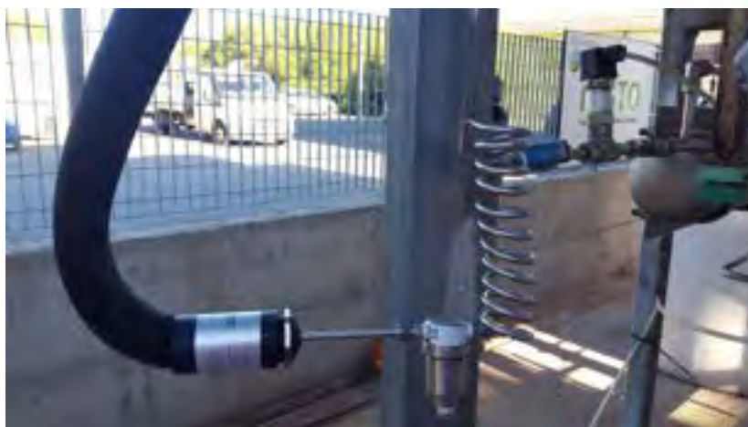
Figura 4.4. Presa di campionamento (serpentina + filtro) e linea riscaldata.
