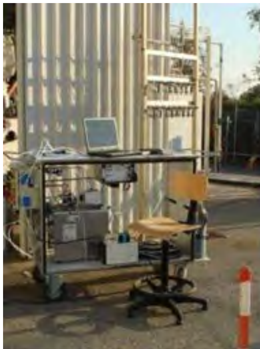
Figura 4.1. Microgas cromatografo Agilent.
