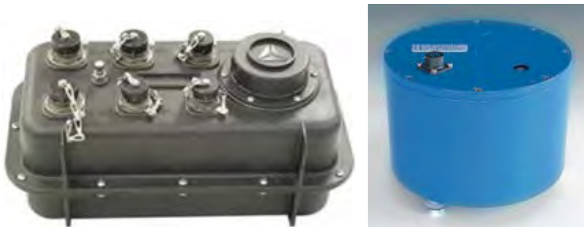
Figura 6. Acquisitore/digitalizzatore 24 bit di tipo Reftek-130_1 (a sinistra) e velocimetro a medio periodo di tipo Lennartz 3D/5s (a destra). Le immagini dei due oggetti non sono in scala tra loro.
