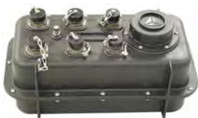
Figura 5. Acquisitore/digitalizzatore 24 bit di tipo Reftek-130_1 (a sinistra) e velocimetro a medio periodo di tipo Sara SSXX 0.2 Hz (a destra). Le immagini dei due oggetti non sono in scala tra loro.
