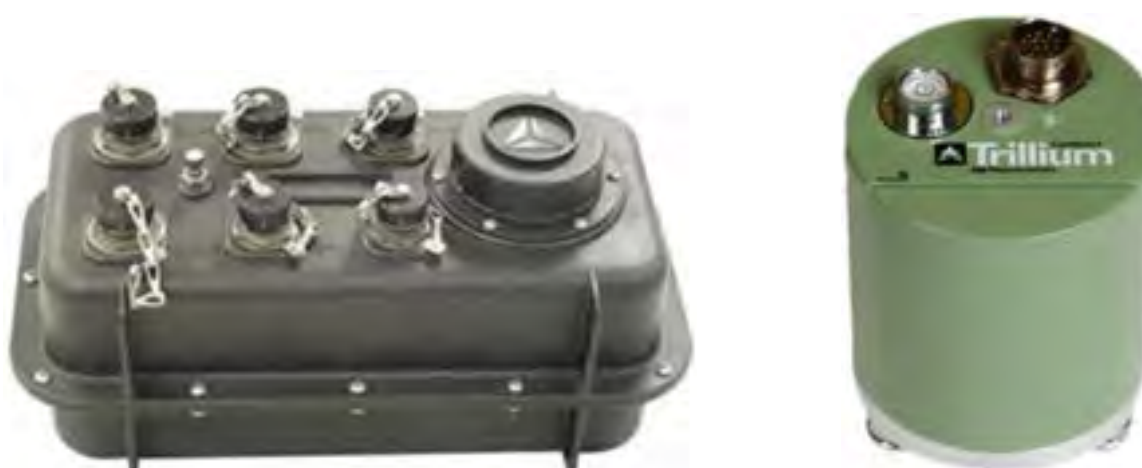
Figura 7. Acquisitore/digitalizzatore 24 bit di tipo Reftek-130_1 (a sinistra) e velocimetro a larga banda di tipo Trillium compact 120 s (a destra). Le immagini dei due oggetti non sono in scala tra loro.
