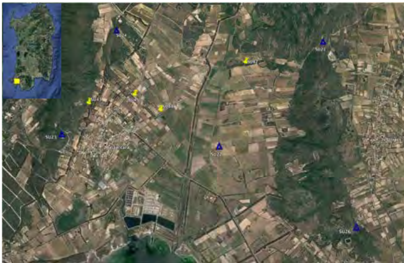
Figura 3. Mappa delle stazioni de progetto installate nell'area del permesso minerario denominato "Monte Ulmus" nel periodo compreso tra la metà di giugno e la fine di settembre del 2017. I triangoli in blu rappresentano la posizione delle 5 stazioni temporanee della rete installata nel 2016, mentre i pin gialli rappresentano le stazioni installate durante il periodo estivo del 2017.
