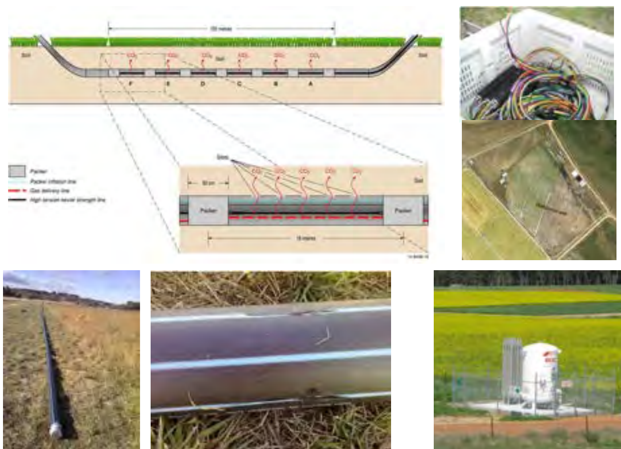
Figura 8. (a) Schema del pozzo orizzontale perforato nel sito Ginniderra; (B) foto aerea del sito; (C) sistema packer prima dell'installazione; (D) il tubo di iniezione; (E) Primo piano del tubo di iniezione scanalato; (F) serbatoio di alimentazione della CO 2 sulla superficie (Feitz, 2013; Feitz, 2014; Feitz et al, 2014).
