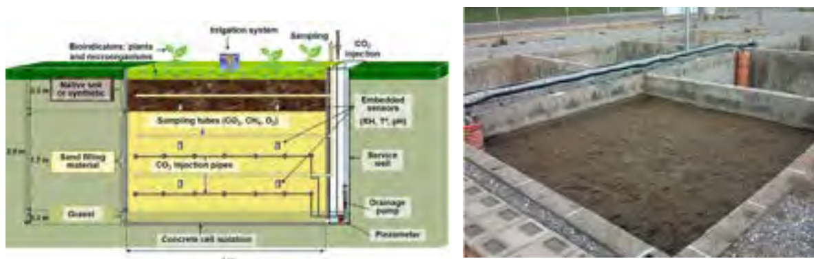
Figura 4. PISCO2 Disegno schematic del sito (a) e foto di una delle celle di cemento riempite con la sabbia (b).
