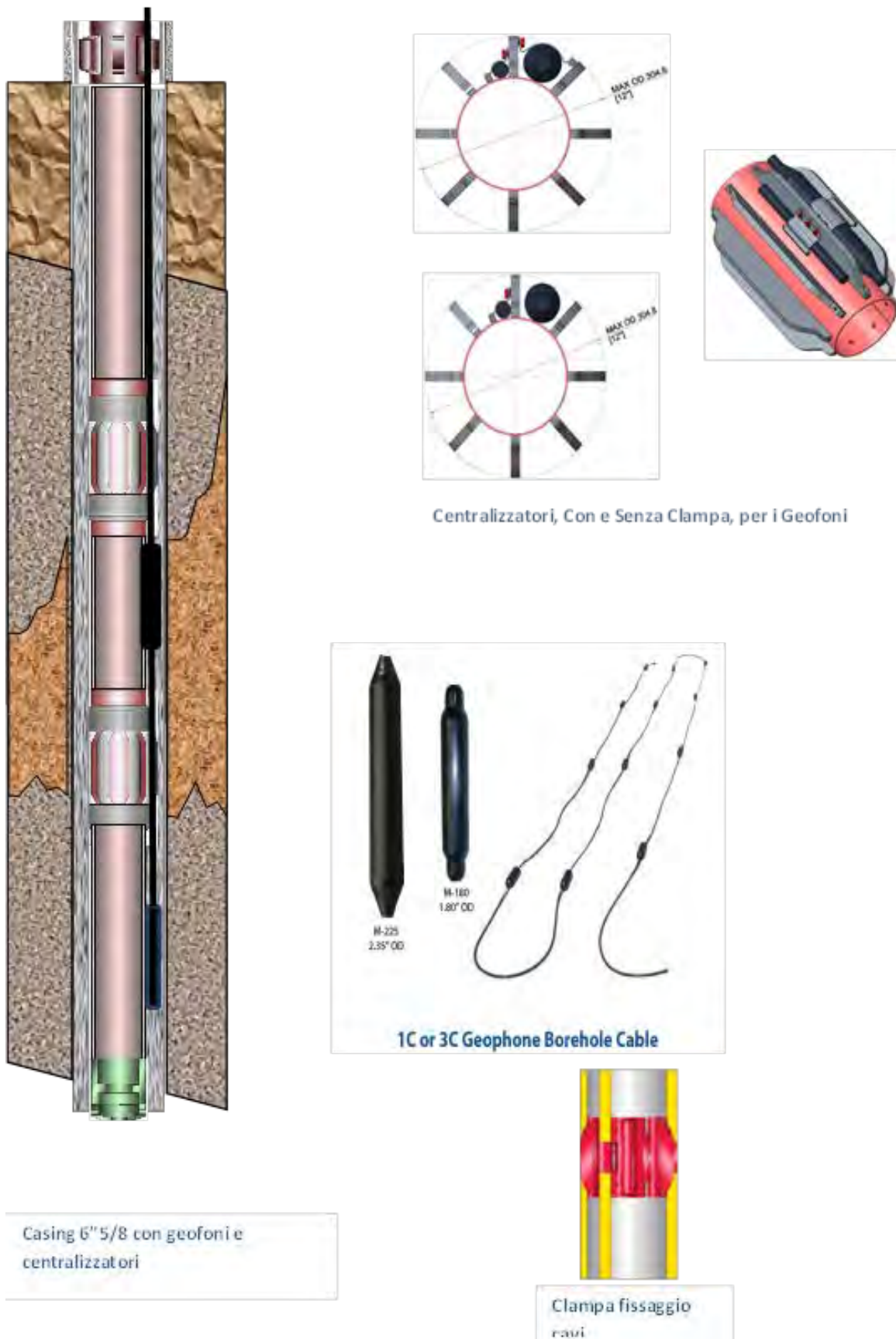
Figura 19 Configurazione CSG strumentato & dettaglio componenti.
