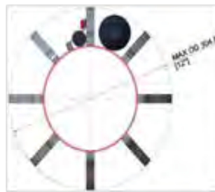
Centralizzatori, Con e Senza Clampa, per i Geofoni
