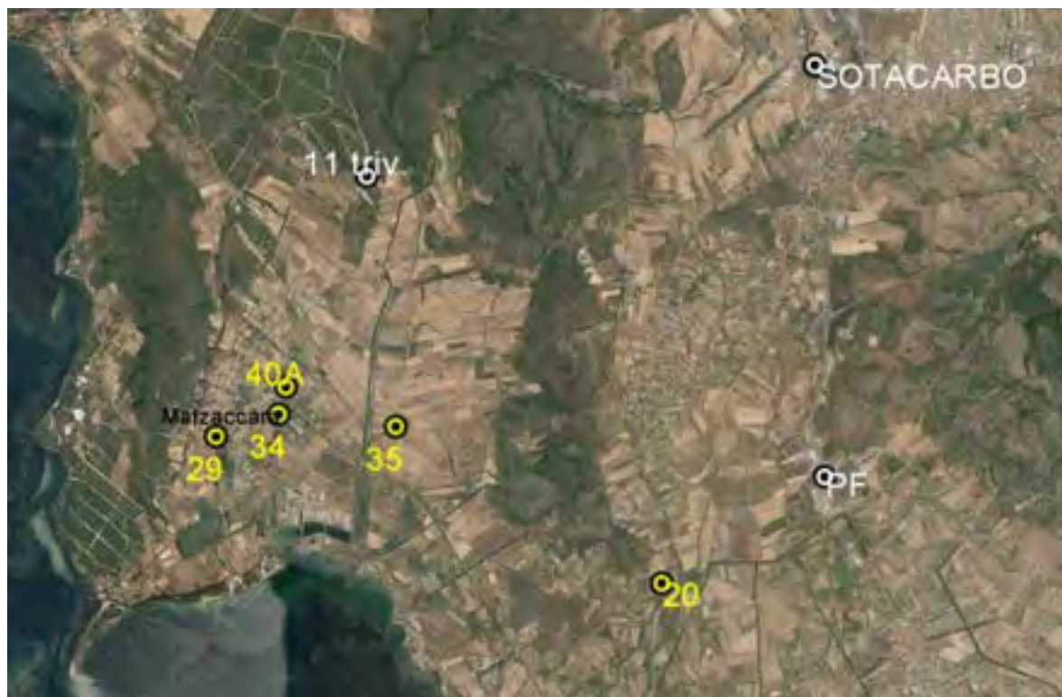
Figura 15. Localizzazione dei pozzi superficiali (in giallo) e profondi (in bianco), all'interno dei quali sono installate le sonde di monitoraggio GasPro.
