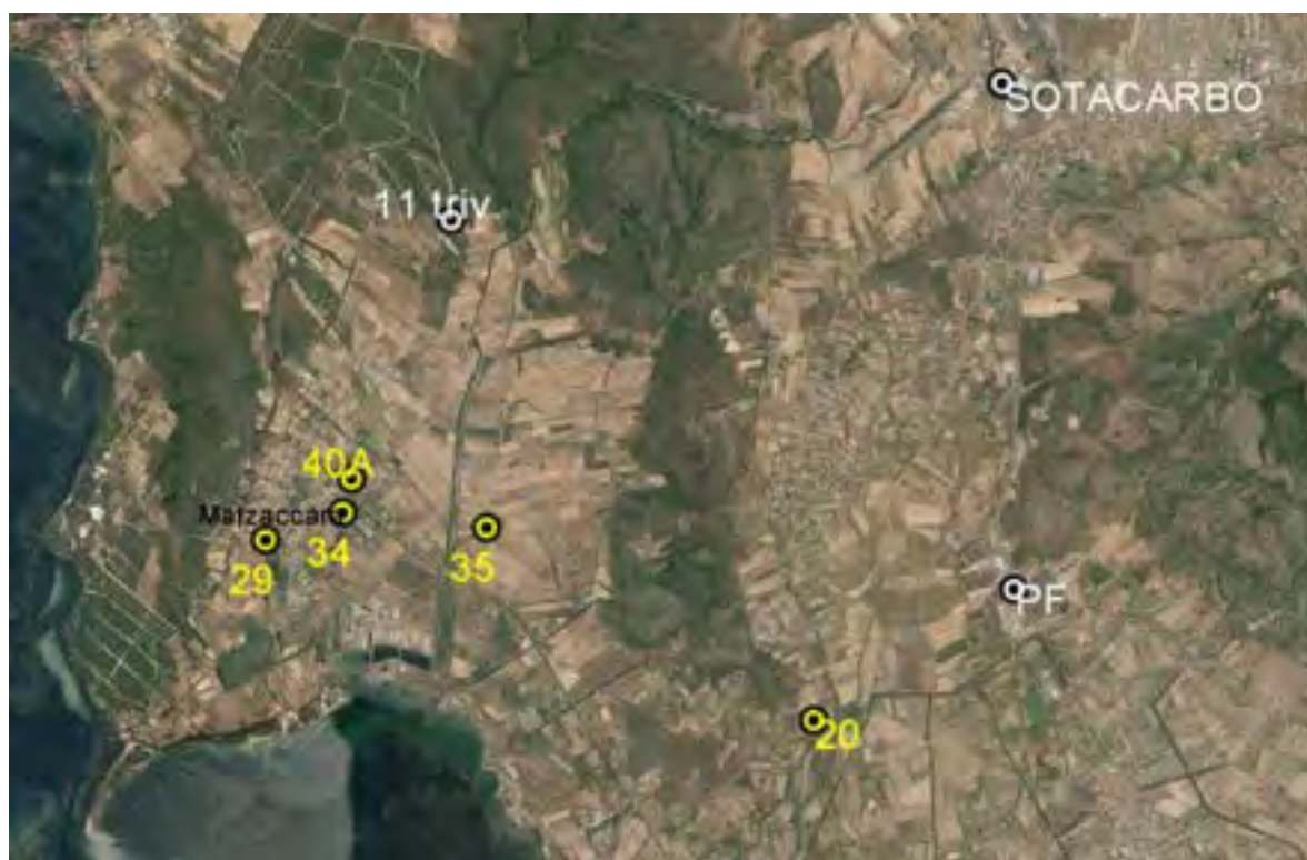
Figura 2 Localizzazione dei pozzi superficiali (in giallo) e profondi (in bianco), all'interno dei quali sono installate le sonde di monitoraggio GasPro.
