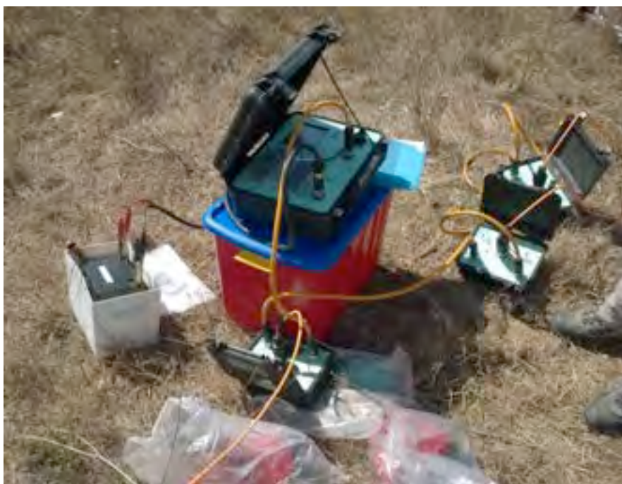
Figura 1 Strumentazione utilizzata per l'acquisizione dei dati di tomografia elettrica
