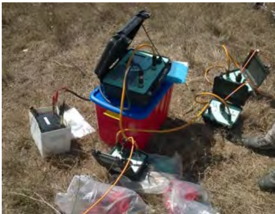
Figura 12 – Strumentazione utilizzata per l'acquisizione dei dati di tomografia elettrica.
