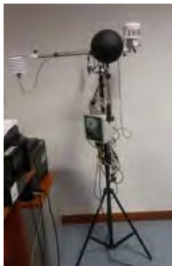
Figura 3.1.1 Centralina microclimatica Grillo MMTS.
