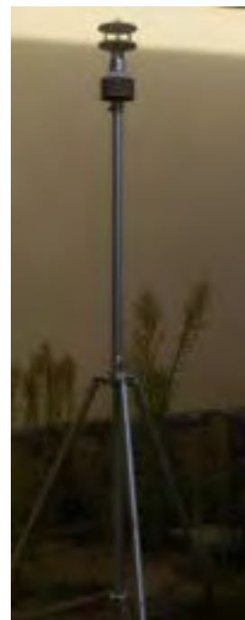
Figura 3.2.2 Sistema di acquisizione variabili termoigrometriche.
