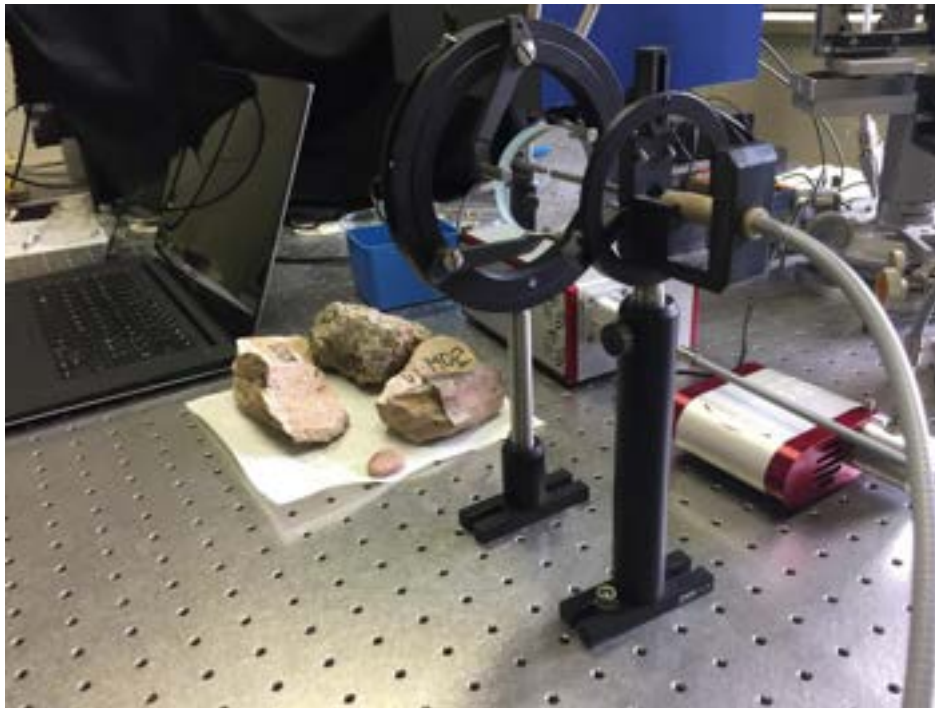
Fig. 5. Il setup di misura ottica nel MWIR, configurazione con lo specchio di riferimento montato.
