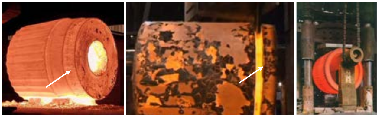
Fig. 8. Cilindro cavo con masselotte indicata dalla freccia bianca (sinistra e centro) e sua lavorazione (destra) per allargamento del foro centrale.
