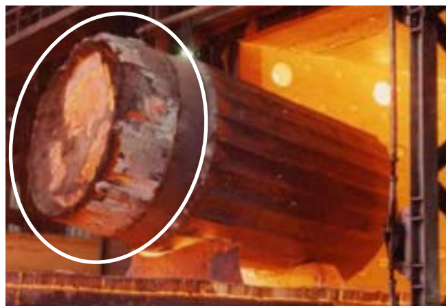
Fig. 7. Cilindro massiccio in acciaio: la masselotte è indicata nell'ellissi bianca.
