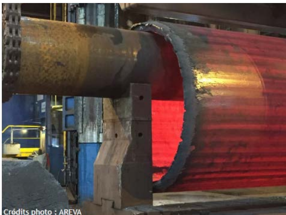
Fig. 9. Lavorazione del foro centrale di cilindro massiccio in acciaio.
