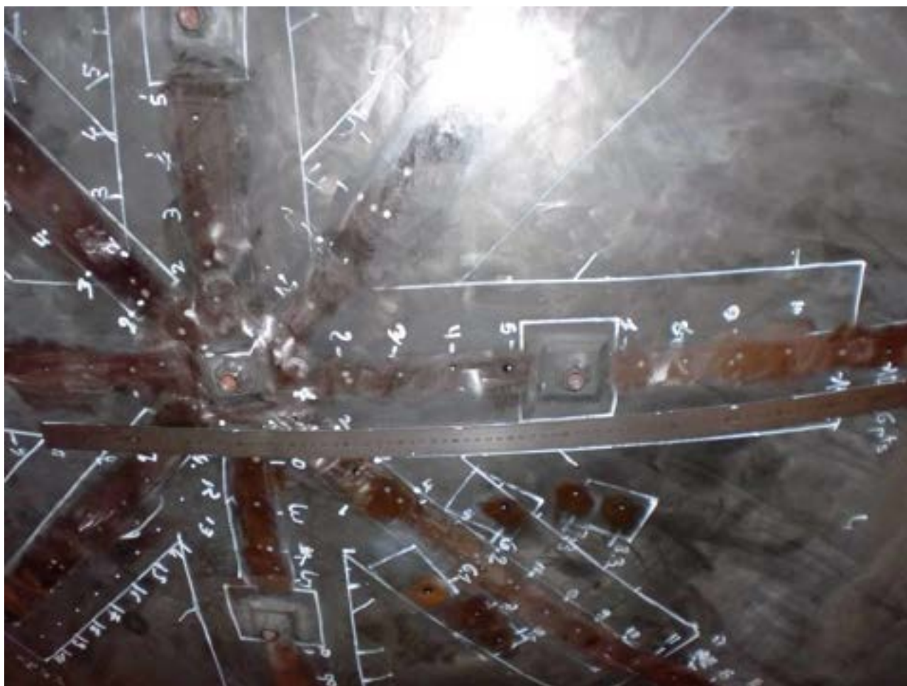
Fig. 21. Chinon 2: mappatura punti di misura da sottoporre a spettrometria sul fondo del GV2.
