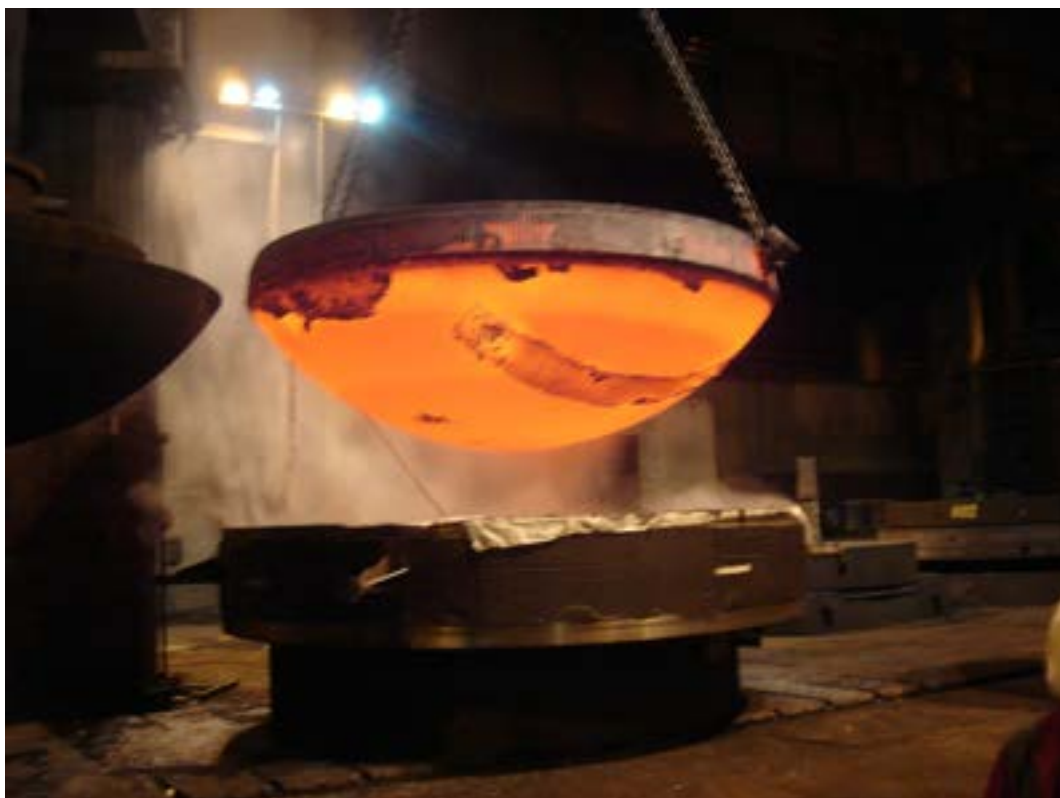
Fig. 19. Lo stabilimento di Creusot Forge: lavorazione di un fondo.
