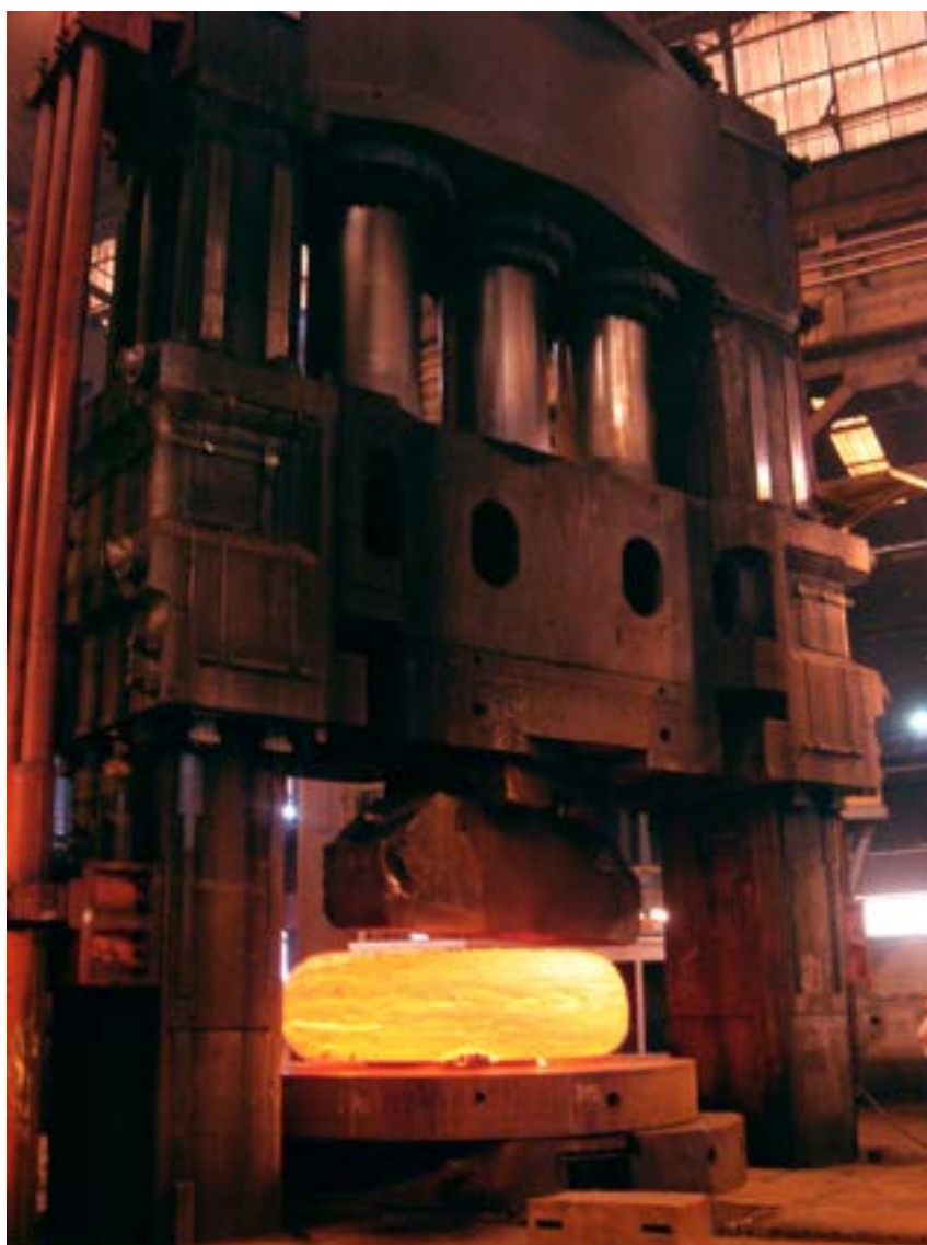
Fig. 20. Lo stabilimento di Creusot Forge: pressatura di un lingotto da fusione.
