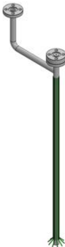
Figura 6 Vista 3D della nuova baionetta realizzata per la configurazione PROPHET-2 con gli elementi riscaldanti
