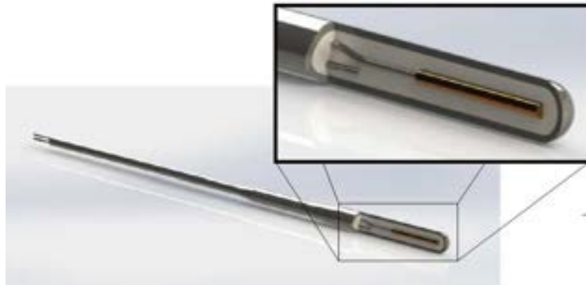
Figura 5 - Disegno concettuale del rivelatore SPND Thermocoax standard.
