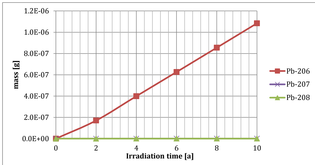
Figura 16 – Accumulo delle maggiori specie venutesi a creare durante l’irraggiamento di un SPND alimentato con ^{209}\text{Bi} . Come risulta evidente, anche per valori di fluensa nell’ordine di 4\text{E}+20 \text{ n/cm}^2 , i prodotti di attivazione della composizione isotopica originale sono, in quantitativo, ordini di grandezza inferiore alla massa del materiale sensibile: l’unico isotopo maggiormente significativo è lo ^{206}\text{Pb} , principale prodotto della catena di decadimento del ^{210}\text{Bi} prodotto per attivazione del ^{209}\text{Bi} , che risulta stabile.
