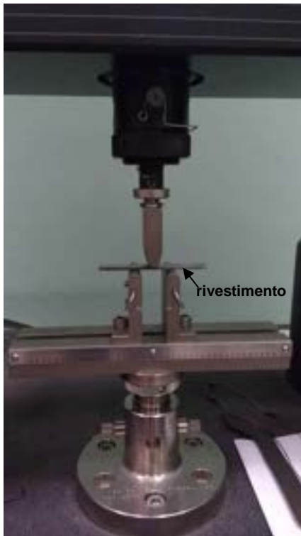
Figura 8. 3 - Provino del campione 66/16 sottoposto a prova di flessione a 3 punti
