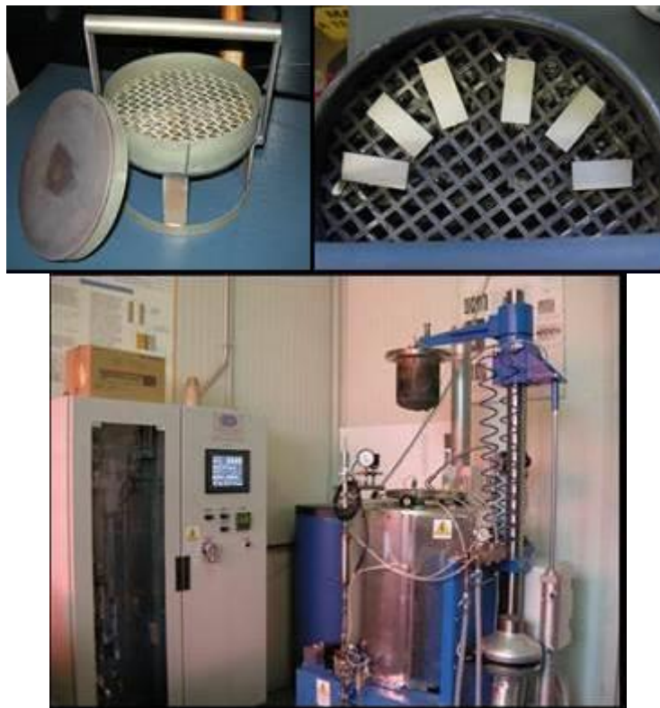
Figura 4.1 ó Impianto CSM pack cementation: (sopra) dettagli del retort e (sotto) impianto
