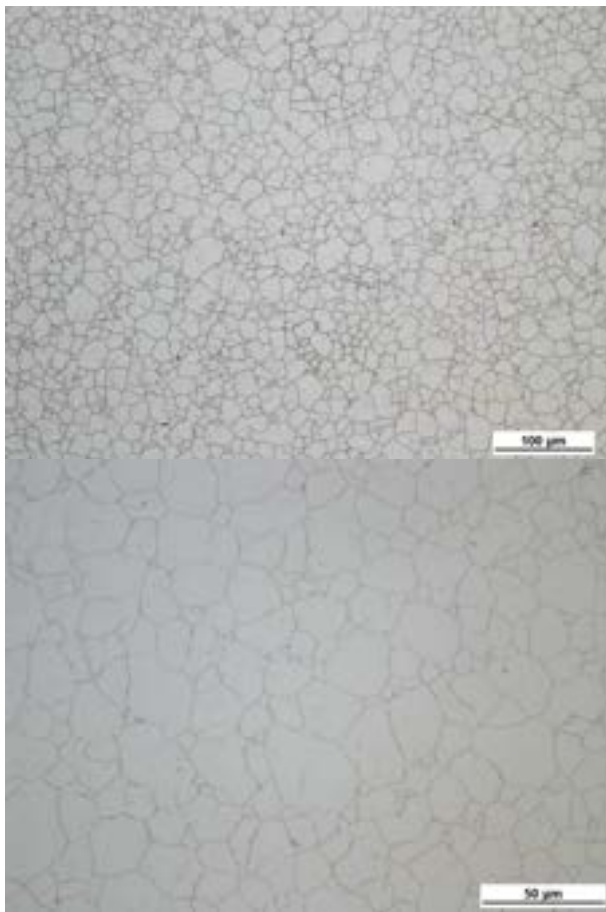
Figura 4.19 - Analisi OM (20X sinistra, 50X destra) della microstruttura dell'acciaio AISI316 sottoposto a trattamento di alluminizzazione (8 ore@750°C) dopo attacco chimico per evidenziarne il grano austenitico
