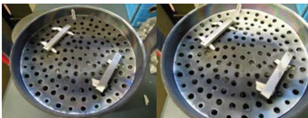
Figura 4.5 - Aspetto dei provini prima (sinistra) e dopo (destra) il trattamento di alluminizzazione a 750 °C con stasi di 8 ore
