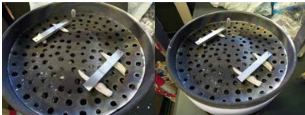
Figura 4.4 - Aspetto dei provini prima (sinistra) e dopo (destra) il trattamento di alluminizzazione a 850 °C con stasi di 4 ore
