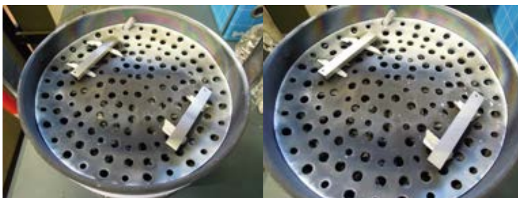
Figura 4.6 - Aspetto dei provini prima (sinistra) e dopo (destra) il trattamento di alluminizzazione a 800 °C con stasi di 6 ore
