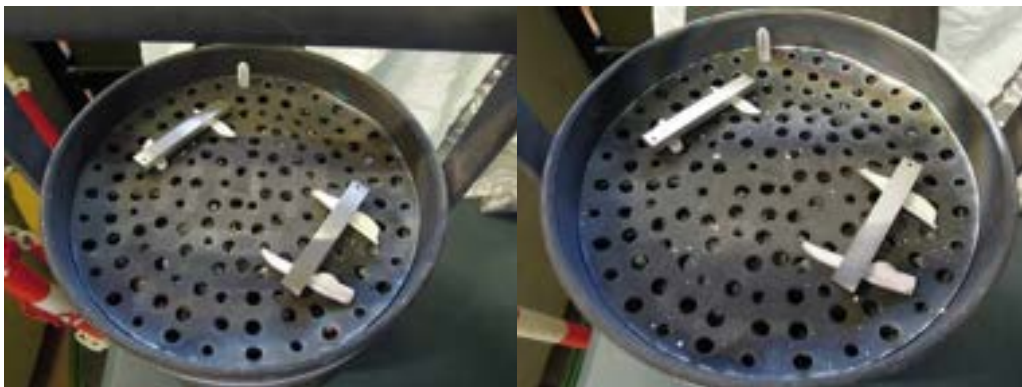
Figura 4.3 ó Aspetto dei provini prima (sinistra) e dopo (destra) il trattamento di alluminizzazione a 900 °C con stasi di 2 ore
