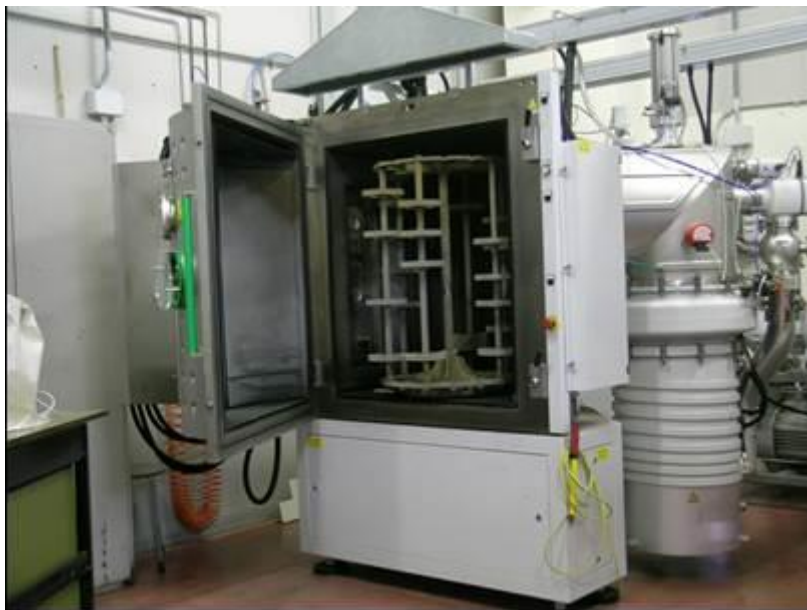
Figura 3.1 ó Impianto di deposizione PVD
