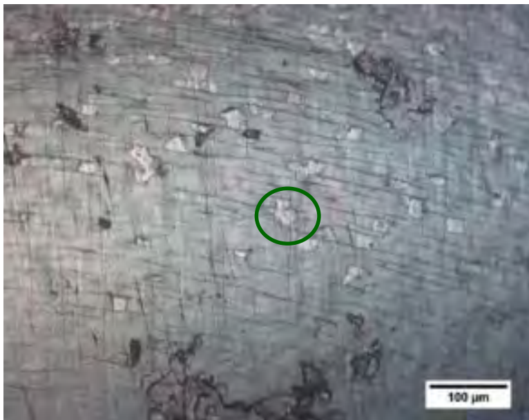
1 \mu\text{m} \text{Al}_2\text{O}_3 /tubo 316L dopo ciclaggio termico
