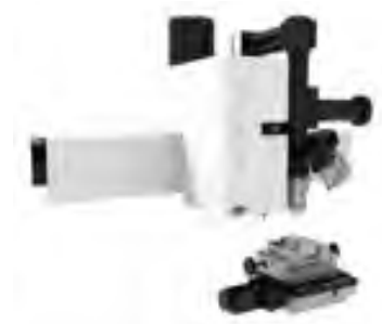
Scratch test UNI EN 1071-3:2005
