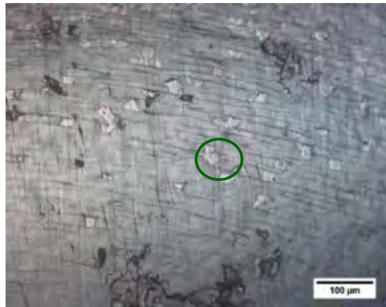
1 \mu\text{m} \text{Al}_2\text{O}_3 /tubo 316L dopo ciclaggio termico
