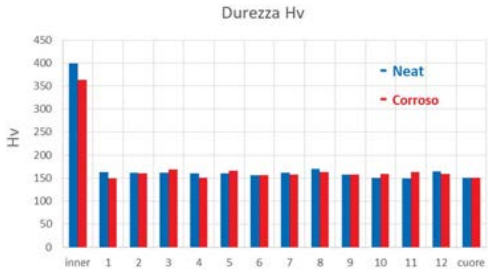
Fig.56 b) Andamento delle microdurezze Vickers del campione prima (blu) e dopo (rosso) esposizione in Pb fuso
