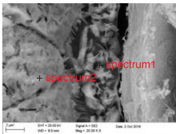
Fig.48 Micrografia SEM diffusion coating particolare Layer esterno post attacco chimico spettri EDX
