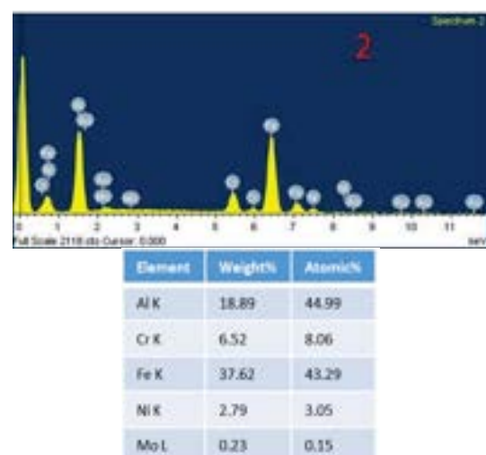
Fig.13 (b) Spettro EDS e composizione elementare del punto 2 di Fig. 12
