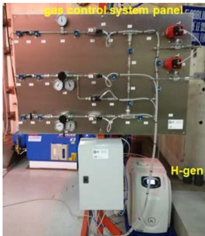
Figura 2: Sistema di controllo gas che include il generatore di idrogeno (H-gen) e il sistema di iniezione delle miscele Ar-H 2 e Ar-O 2 .
