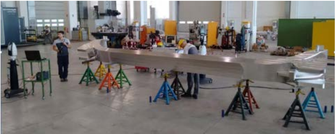
Figura 11: Controlli dimensionali finali della gamba dritta effettuati da due operatori con 2 laser tracker.
