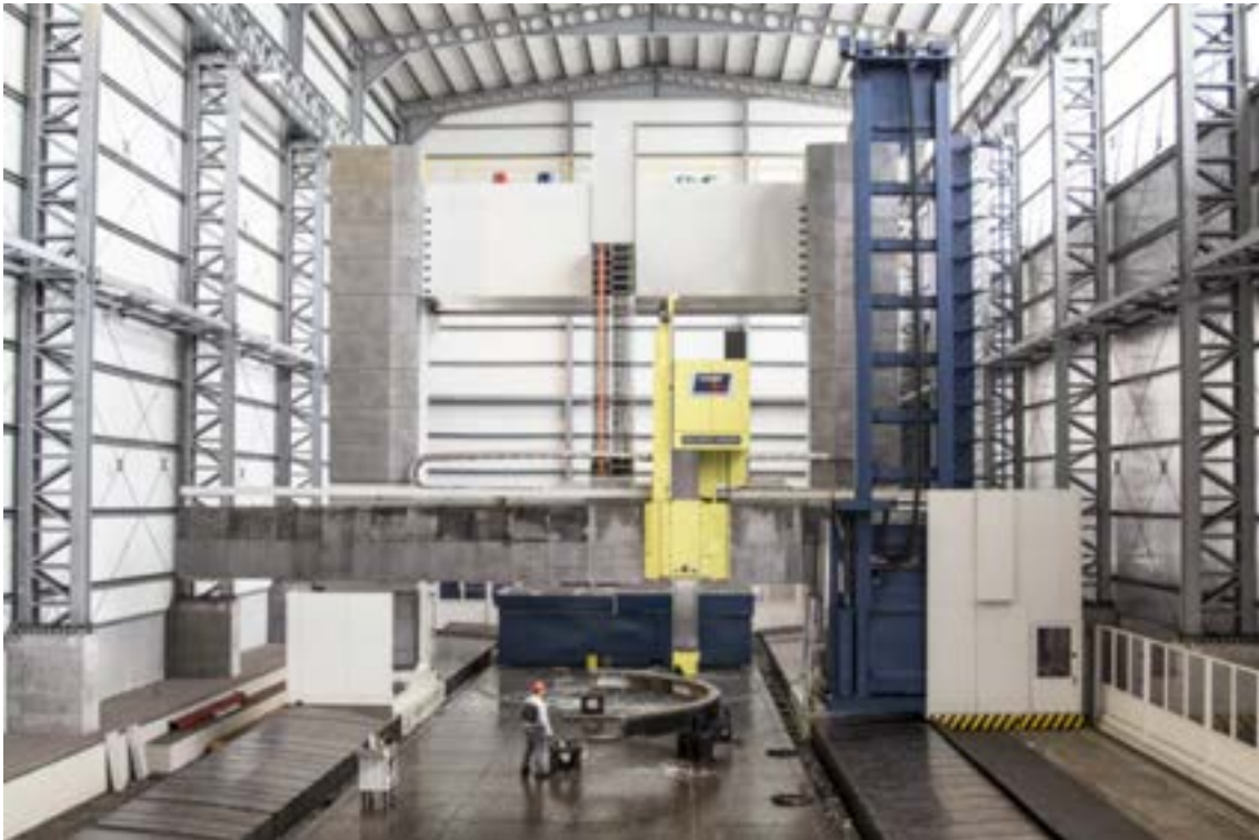
Figura 3: Lavorazioni di macchina sulla parte esterna della gamba curva nello stabilimento della ditta Walter Tosto a Ortona.
