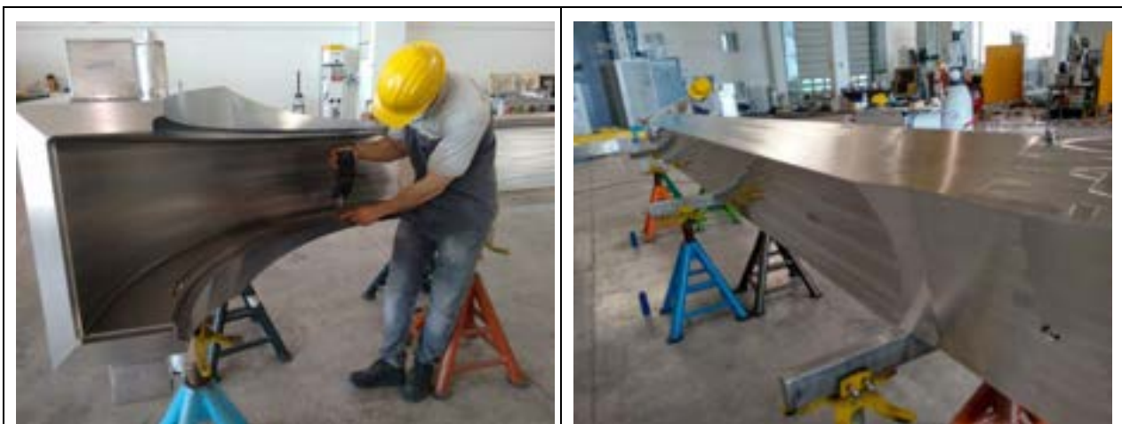
Figura 12: Controllo dimensionale della gamba dritta; particolare della misura effettuata con lo strumento T-probe.
