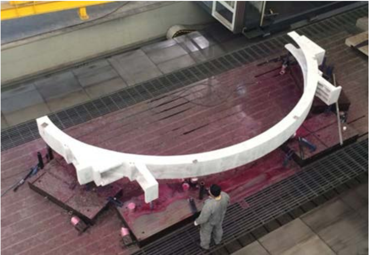
Figura 8: Controlli con liquidi penetranti sulla gamba curva al termine delle lavorazioni finali di macchina.
