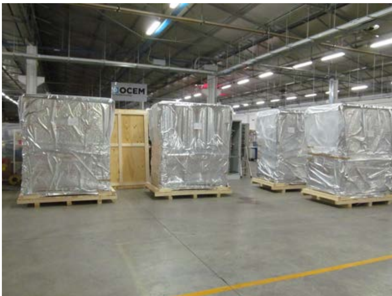
Figura 10. Cubicoli inseriti nelle sacche “moisture-proof” prima di richiuderli nelle casse di legno.
