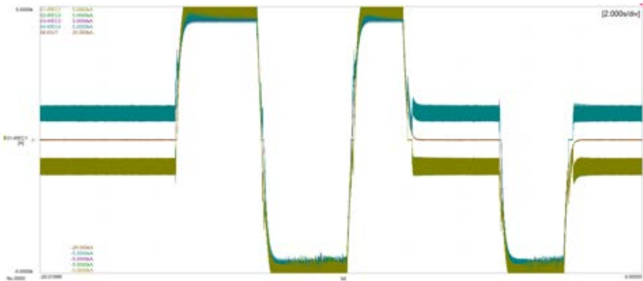
Figura 27 – Prova di tipo a corrente nominale del CS1.
