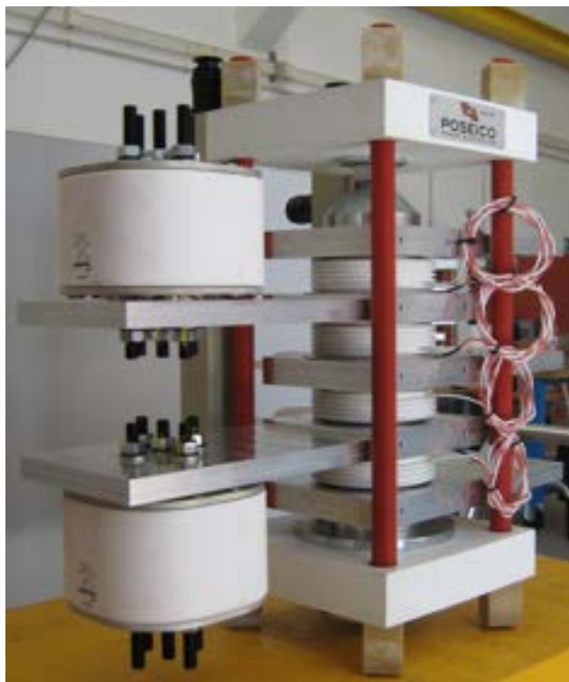
Figura 6 – Dettaglio del CS1 power assembly.
