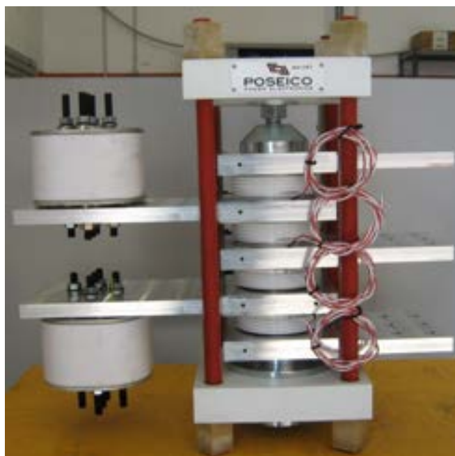
Figura 5 – Vista frontale del CS2 power assembly.
