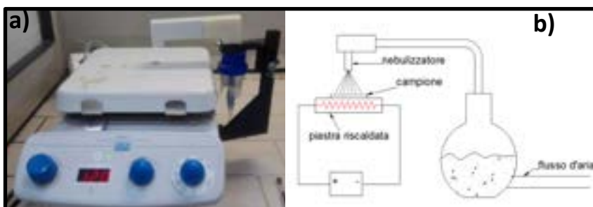
Figura 4. Foto a) e schema b) del sistema di nebulizzazione adattato per depositare da sospensioni colloidali nanoparticelle di metallo. Nell'inset l'ugello costruito ad hoc per i nostri scopi.
