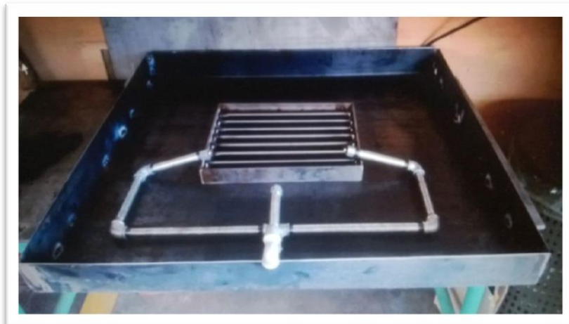
Figura 2. Impianto DETONAT per prove di partecipazione al fuoco
