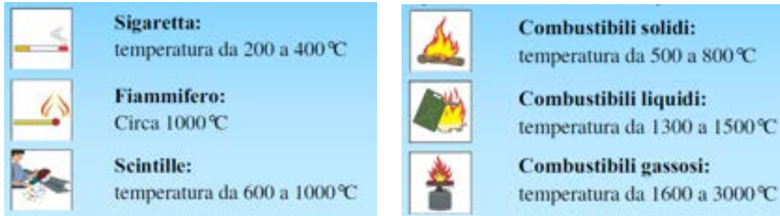
Figura 16. Esempi di temperatura massima di fiamma (Fonte: [17].)
