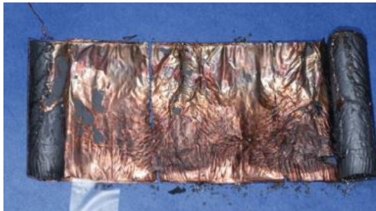
Figura 19 Resti di una cella agli ioni di litio in seguito a runaway termico: il collettore in alluminio è fuso e il separatore consumato; ciò che rimane della cella è il collettore di corrente in rame e un materiale friabile nero composto principalmente da materiale catodico.
