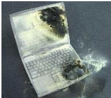
Figura 17 Danneggiamento di un computer portatile in seguito al cortocircuito della batteria agli ioni di litio.
