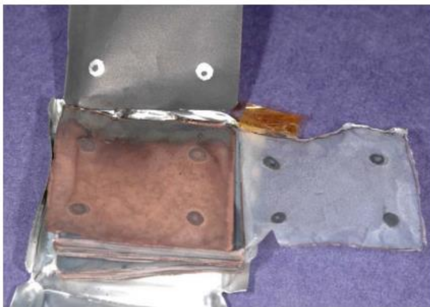
Figura 16 Dissoluzione del collettore di corrente in rame nell'elettrolita di una cella ripetutamente sovra-scaricata.
