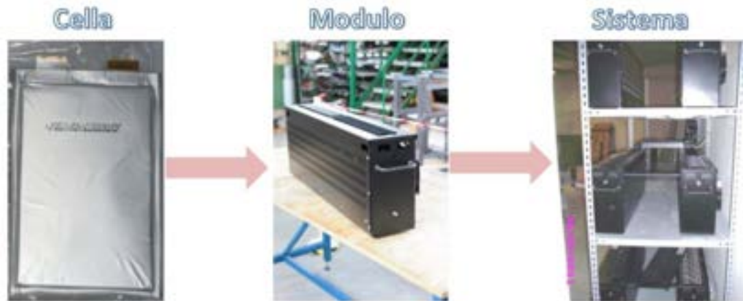
Figura 32 Decomposizione del sistema di accumulo di riferimento ai fini della applicazione di una analisi FMEA.
