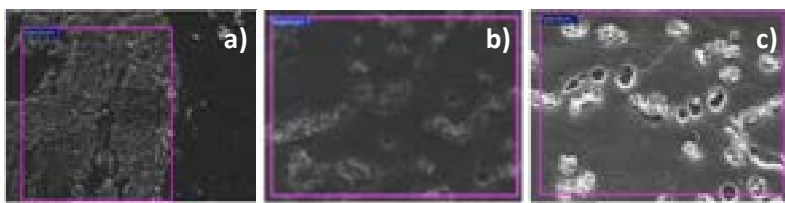
Figura 22. EDS dell'elettrodo di Li utilizzato nelle celle simmetriche Li//Li con a) 2,5m-DME, b) 5m-DME, c) 5m-DD.
