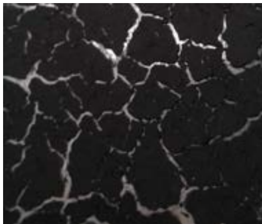
Figura 1. Elettrodo ottenuto per disidratazione lenta di una miscela di materiale attivo carbone, EVA ed acqua.
