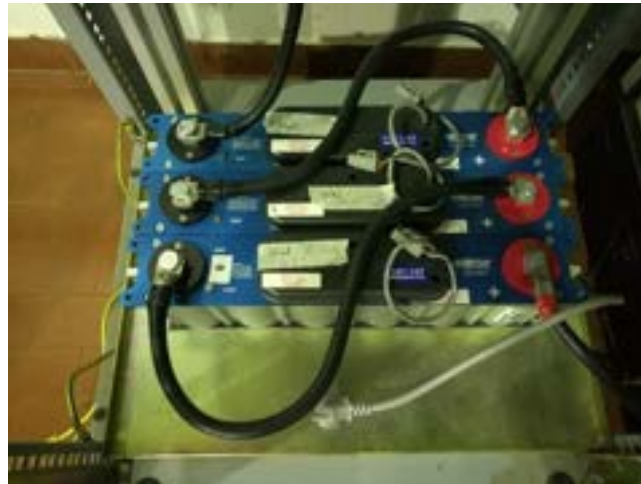
Figura 5. Banco di supercondensatori rappresentativi del sistema di bordo
