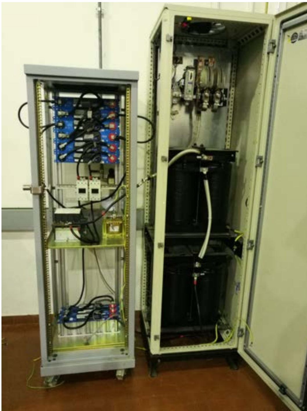
Figura 4. Apparato sperimentale testato: supercondensatori di bordo (in basso a sinistra), supercondensatori della stazione di ricarica (in alto a sinistra) e induttanze (a destra)
