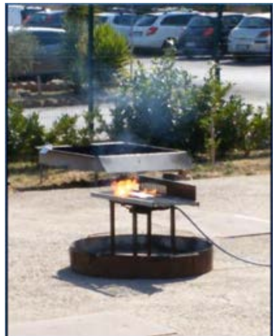
Figura 9. Innesco dei vapori con formazione di fiamma
