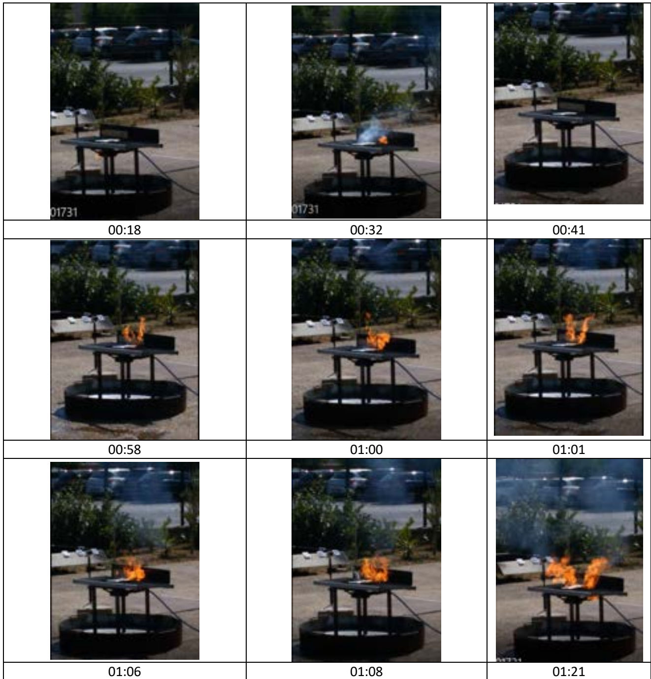
Figura 20. Prova estinzione con polvere: prima dell'estinzione
