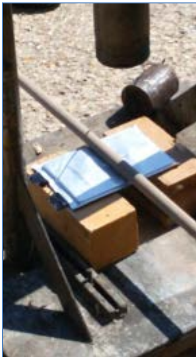
Figura 24. Preparazione della prova di piegatura ( bending )
