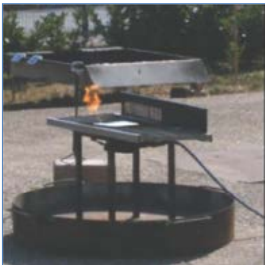
Figura 8. Emissioni di gas e accensione della fiamma
