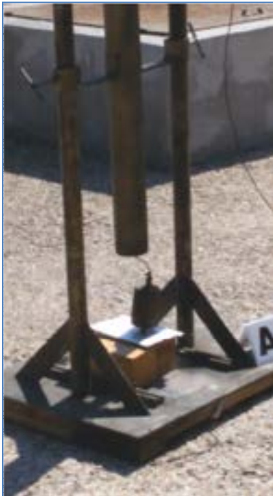
Figura 22. Prova di perforazione
