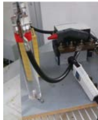
Figura 20. Setup di prova di cortocircuito con cella Tundersky TS LFP 60 Ah
