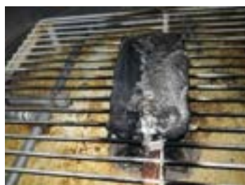
Figura 21. Cella Tundersky TS LFP 60 Ah . Prova di esposizione a fiamma, fino a combustione completa
