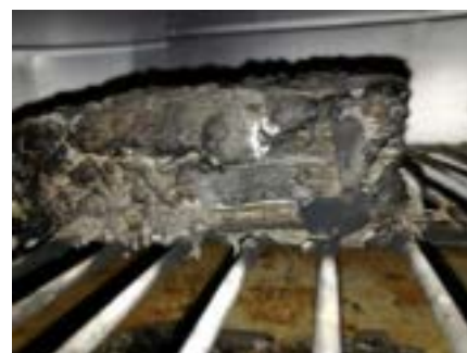
Figura 21. Cella Tundersky TS LFP 60 Ah . Prova di esposizione a fiamma, fino a combustione completa
