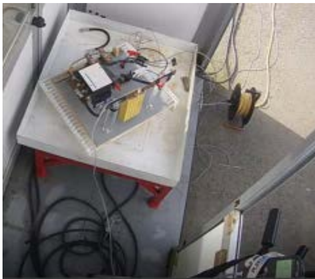
Figura 20. Setup di prova di cortocircuito con cella Tundersky TS LFP 60 Ah
