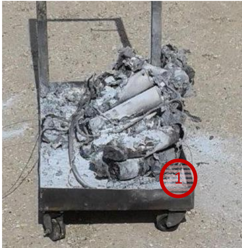
Figura 7 Batteria incendiata, punti di prelievo campioni.
