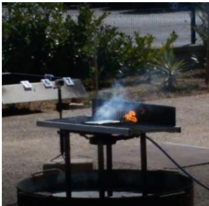
Figura 1 Aerosol emessi dalla cella a seguito di riscaldamento con fiamma.
