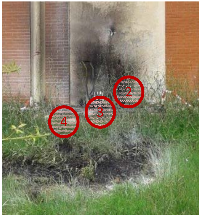
Figura 8 Batteria incendiata, punti di prelievo campioni.
