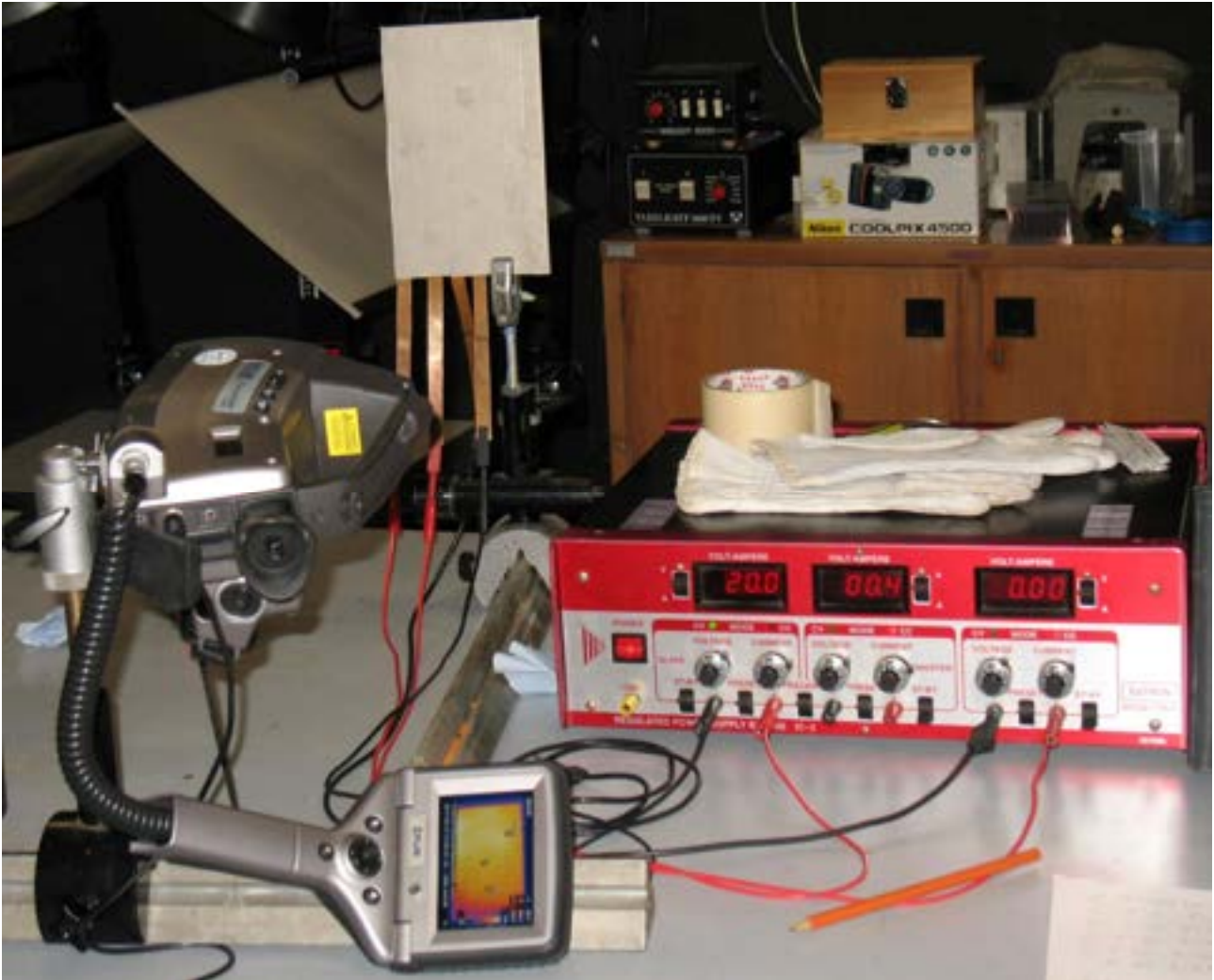
Figura 5 test di riscaldamento di una cella normale e mappatura delle temperature con termocamera
