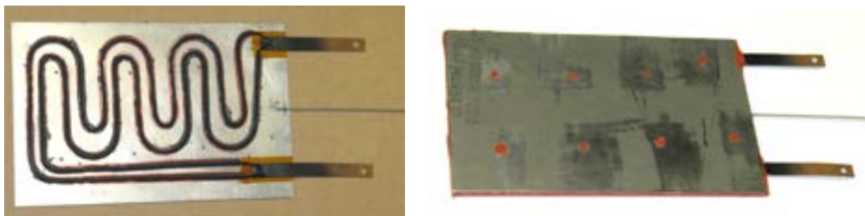
Figura 12 riscaldatore per alta potenza, prima e dopo la chiusura
