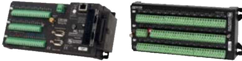
Figura 6. Il datalogger CR1000 usato nella stazione meteo e di radiazione solare.
